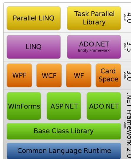
Figura 2.2.2 Estructura actual de componentes del framework.
