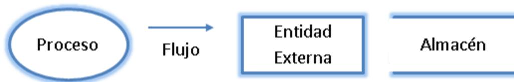
Figura 4.1.1.1 Componentes diagrama de flujo de datos.
