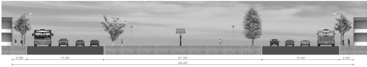
Figura 5.4. Configuración física de la Avenida Ingeniero Eduardo Molina, en el tramo comprendido de Río de Los Remedios al Eje 3 Norte, sección mínima
