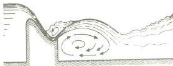
CUBETA AHOGADA CON REMOLINO INFERIOR Y SUPERFICIAL
