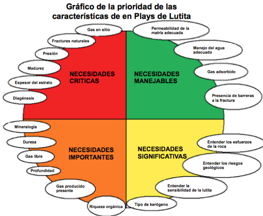
Figura 16 - La importancia de las características de la lutita dependerá de la disponibilidad técnica y los costos para lograr la producción esperada 15 .
