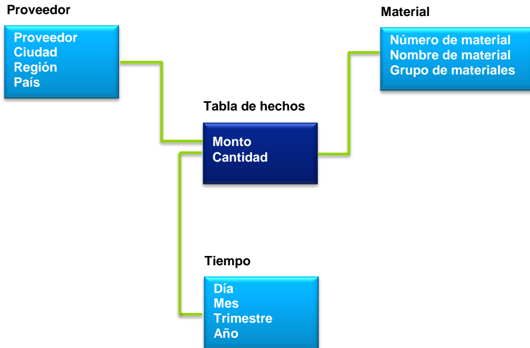
Figura 3.4 Esquema estrella de un InfoCubo.
