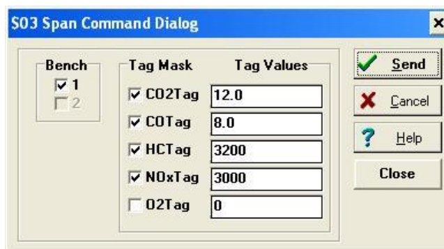
Figura 4.10. Valores de calibración para el analizador de gases.
