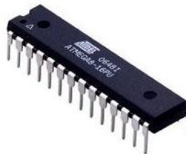
Figura 2.2. Microcontrolador ATmega8 de la empresa ATMEL.
