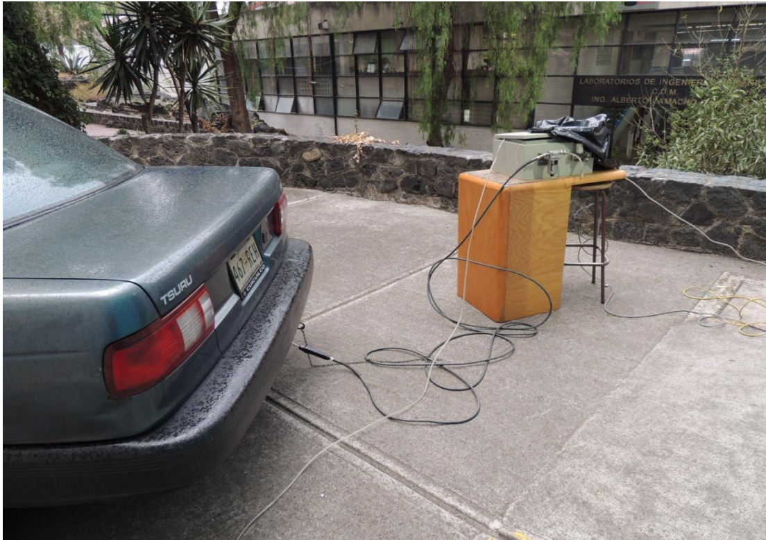
Figura 4.12. Prueba estática al analizador de gases.
