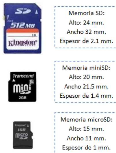
Figura 2.10. Tipos de SD CARD y sus dimensiones.
