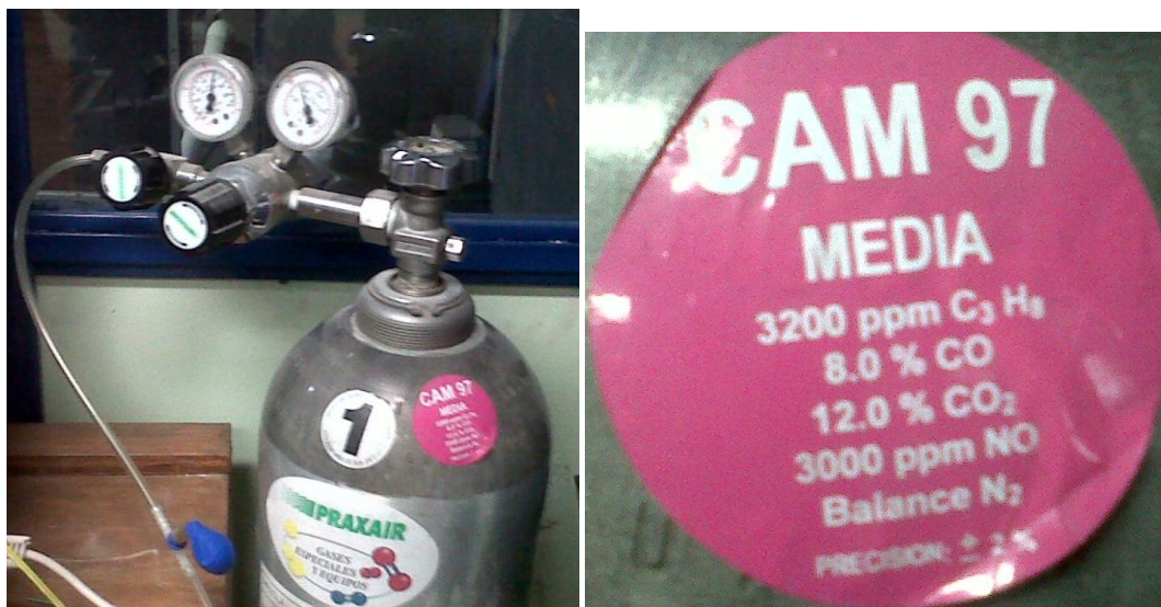
Figura 4.9. Tanque de gases de calibración para el ANDROS 6600.
