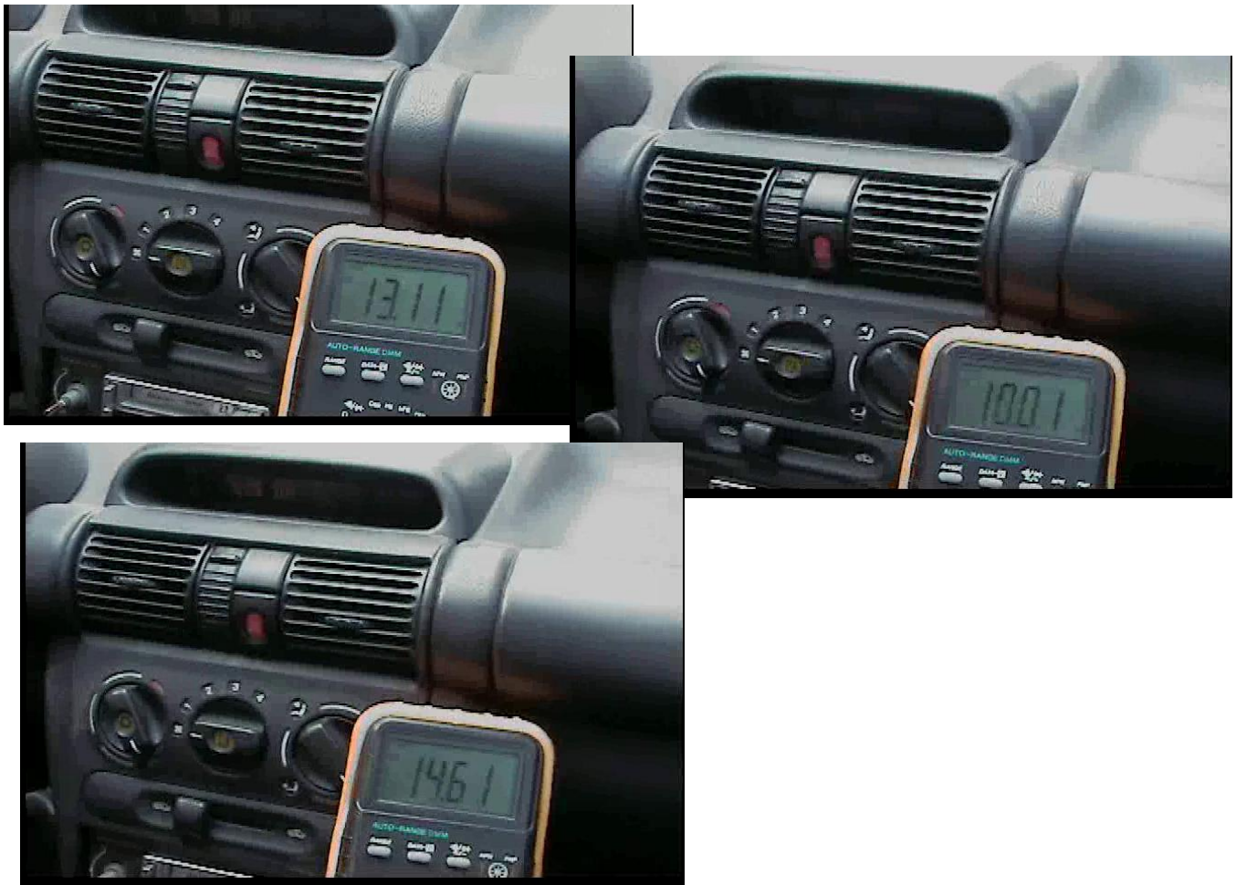
Figura 4.13. Mediciones del voltaje de la batería.
