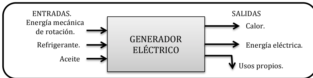
Figura 4.2.1.4. Ecobalance para la operación del generador eléctrico 50 .
