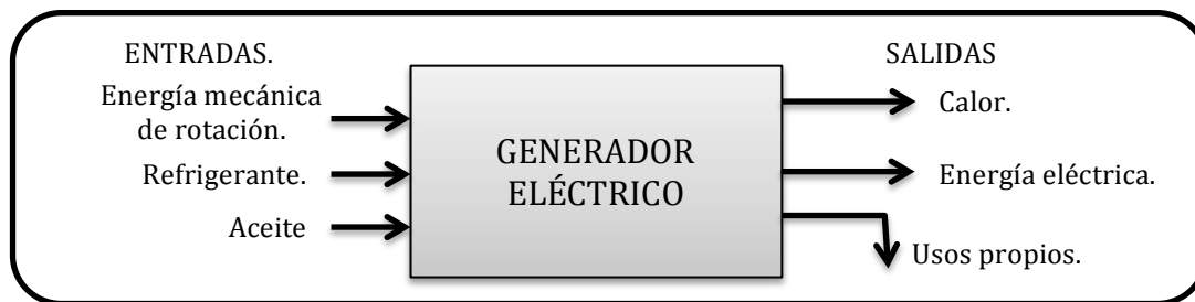
Figura 4.2.2.5. Ecobalance para la operación del generador eléctrico 61 .
