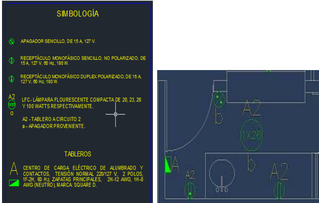
Figura 40. Simbología y levantamiento eléctrico (cocina).
