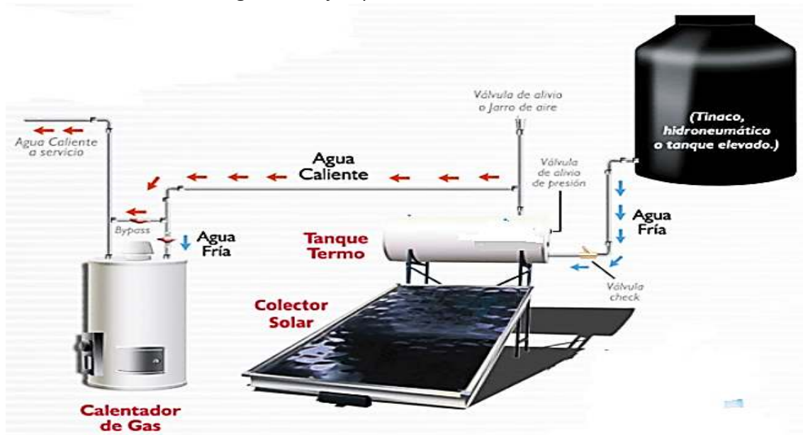
Figura 24. Ejemplo de sistema solar térmico.
