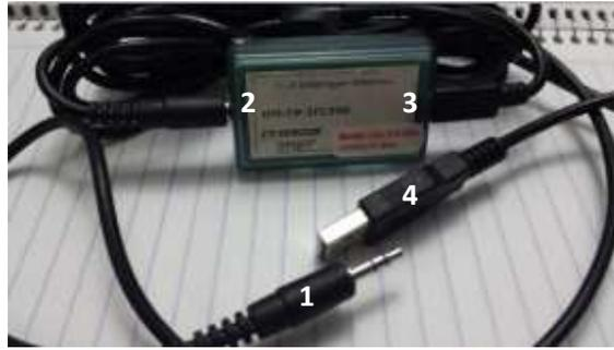
Figura 71. Conexión del sensor OM-CP-SVR101.
