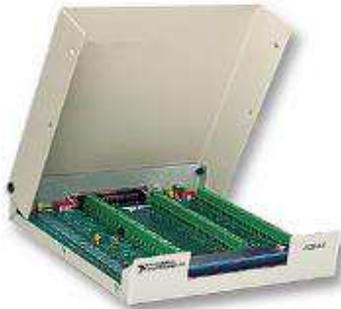
El bloque conector de entradas/salidas que se implementa es el NI SCB-68, éste sirve para realizar interfaz de señales de entradas/salidas a dispositivos de adquisición de datos (DAQ)<sup>13</sup>, por ejemplo la tarjeta NI PCI-6229.
