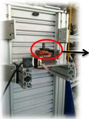
La prueba se realiza con dos motores monofásicos diferentes de 3.988 Kg, obtenidos cada uno de ellos de un compresor (Anexo 4).
