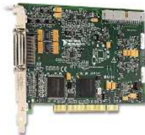
Figura 20. Tarjeta de adquisición de datos NI PCI-6229
