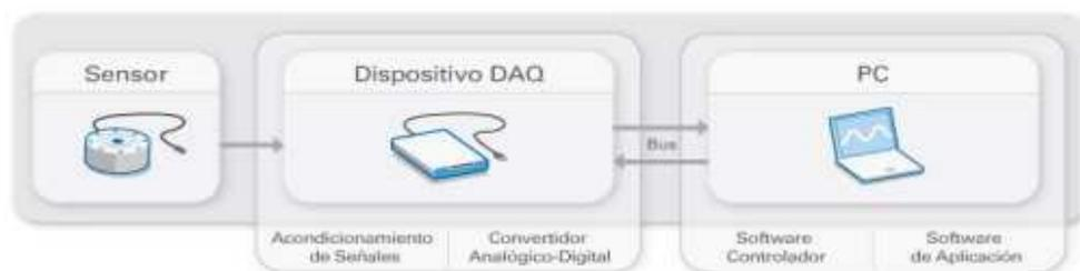
Figura 26. Esquema general de un sistema DAQ.
