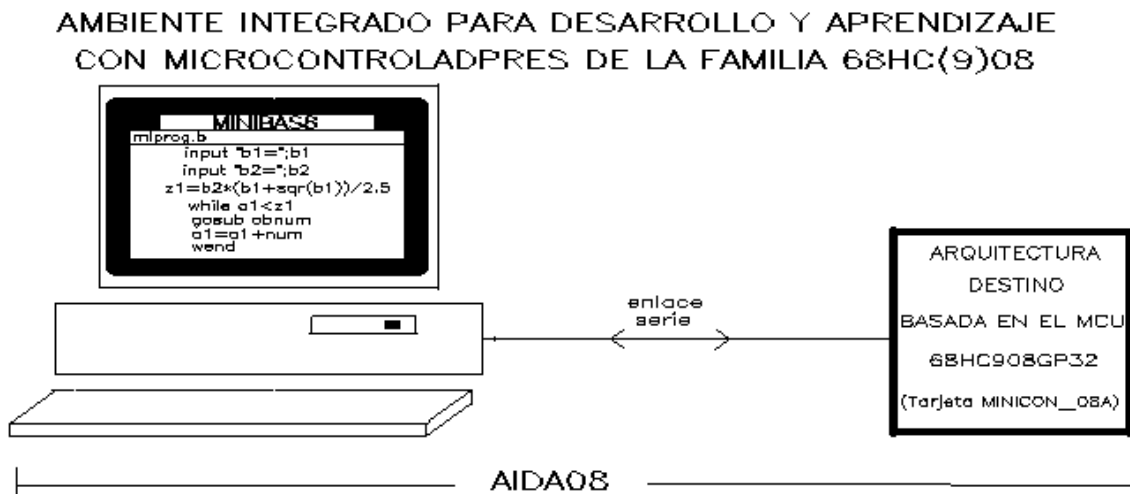
FIGURA 1.2: Esquema del sistema AIDA08. De izquierda a derecha se encuentran la PC el enlace serie y finalmente la tarjeta MINICON_08A.
