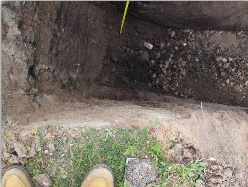
Fig. 4.11. Sondeo exploratorio en terreno natural (PCA) en el km 1+497. Nótese a simple vista la presencia de arcilla color café oscuro; los resultados indicaron que tiene el 7.7 % de expansión.
