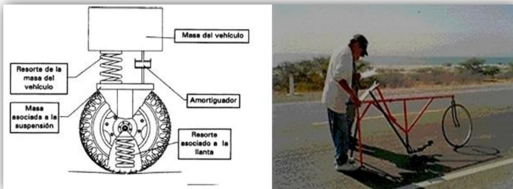
Fig. 2.20. Equipos utilizados para la medición de las deformaciones verticales de un camino. A la izquierda se encuentra el cuarto de carro utilizado en la determinación del IRI; a la derecha el Rugosímetro MERLIN (ref. 35).
