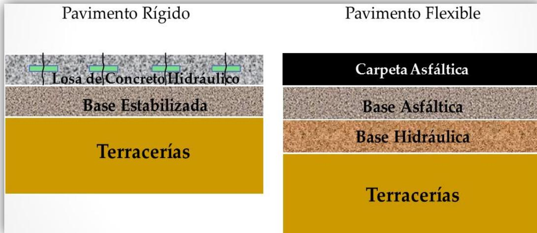
Fig. 2.4. Esquema que muestra las típicas capas que conforman un pavimento, ya sea rígido o flexible (ref. 30).
