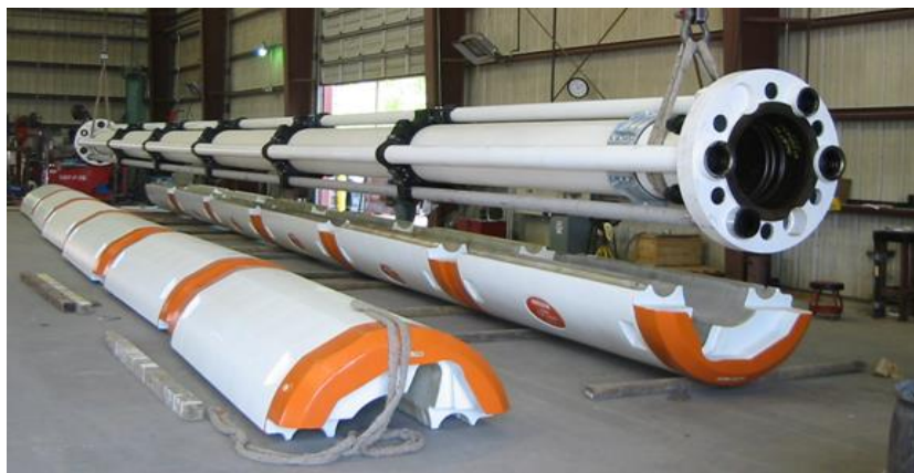
Ilustración 93 Detalle de Riser y elemento de flotación
