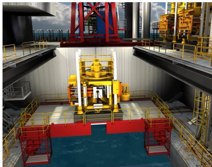
Ilustración 72 Plataforma inferior móvil del X-Mas Tree (Moon Car)
