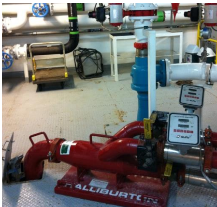
Ilustración 203 "Mix on the fly" de lodo y agua de mar
