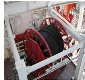
Ilustración 34 Cable de perforación
