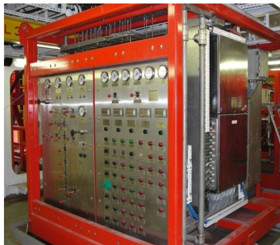
Ilustración 64 Unidad de Control del Diverter
