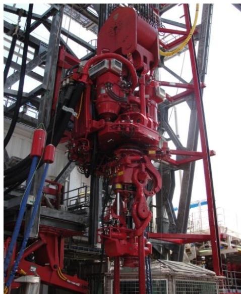
Ilustración 32 Bloque y Top Drive de la PSS Bicentenario
