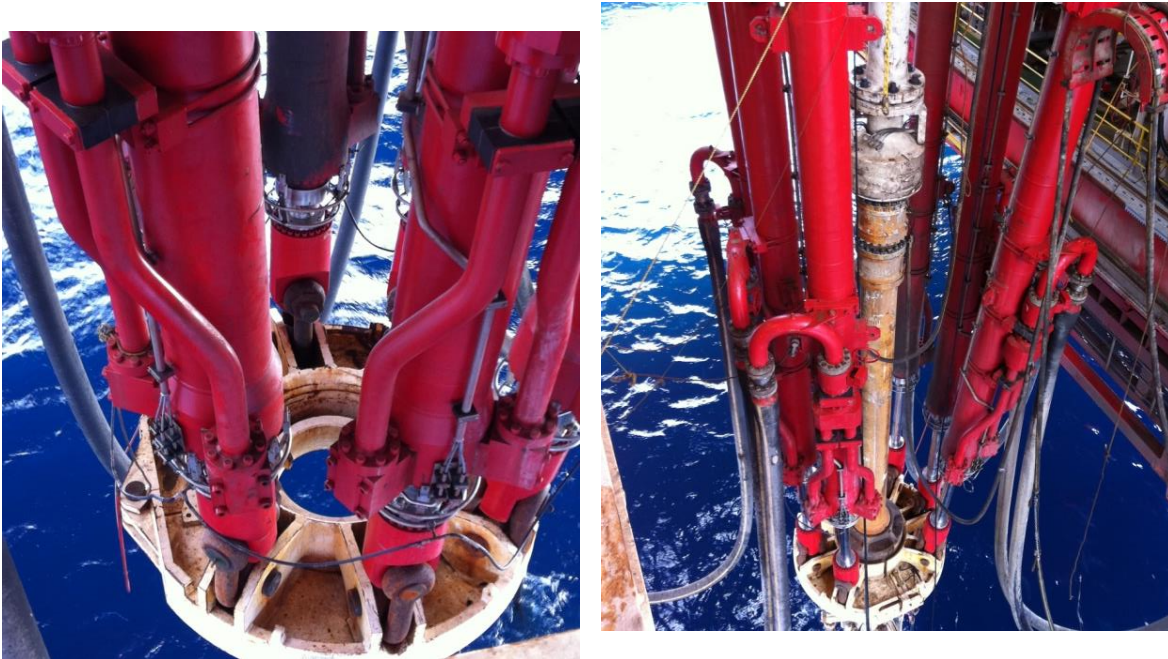
Ilustración 91 Detalle del anillo tensionador del Riser
