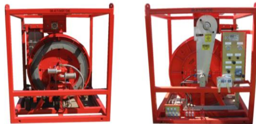
Ilustración 78 Carrete para la válvula de autollenado
