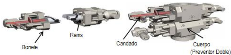
Ilustración 109 Detalle de los componentes principales de un preventor doble de Cameron
