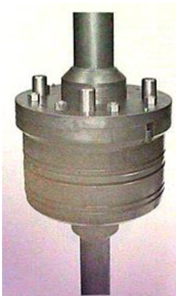
Ilustración 120 Herramienta para correr el cabezal de 30 in y TR de 30 in
