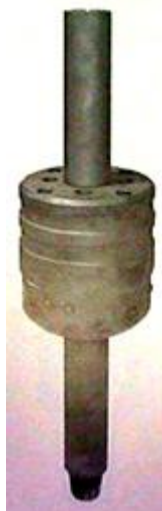
Ilustración 128 Herramienta para correr y recuperar los bujes de desgaste
