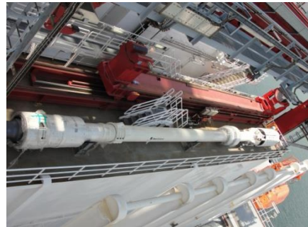
Ilustración 42 Máquina alimentadora de tubería (Riser)
