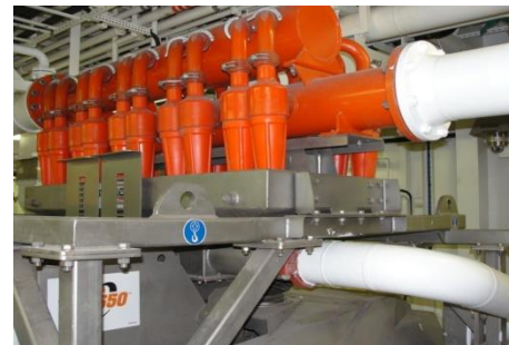
Ilustración 52 Unidad limpiadora de lodo con desarcillador de 20 conos
