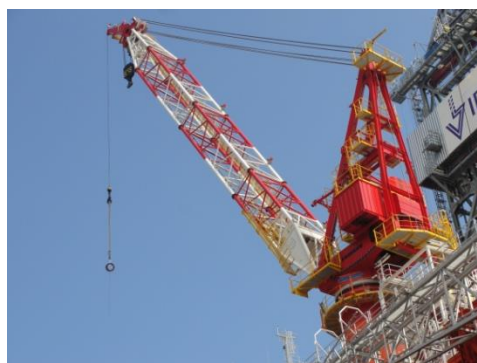
Ilustración 60 Grúas principales de levantamiento de equipo
