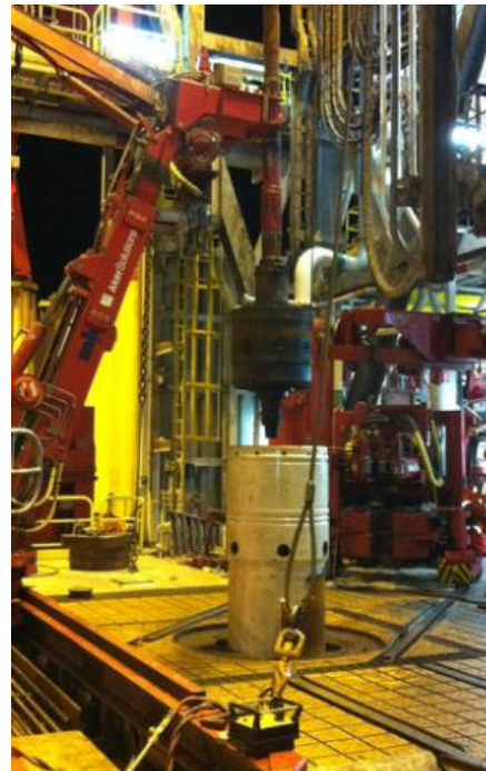
Ilustración 136 Herramienta CADAT entrando al cabezal de baja presión de 36 in
