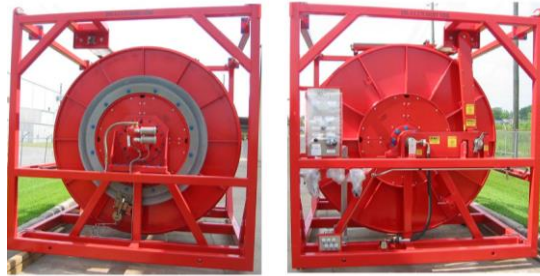
Ilustración 77 Manguera de la línea caliente
