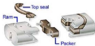
Ram fijo de tubería
