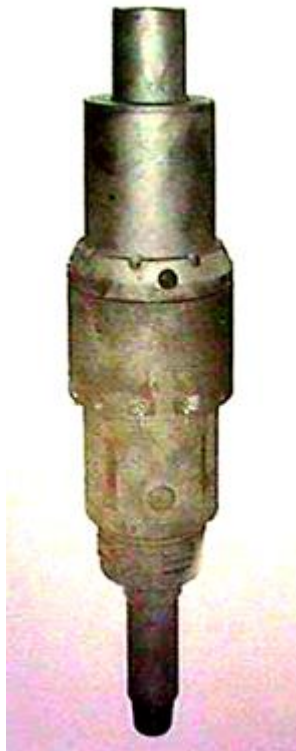
Ilustración 124 Herramienta para correr y probar la TR, colgador y ensamble sello (CHSART).
