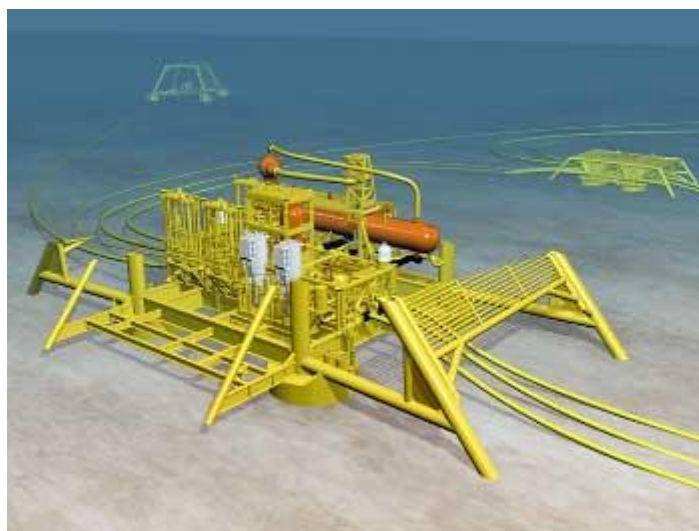
Figura 14. Unidad de separación submarina 11
