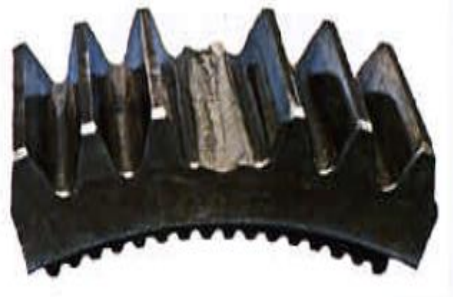
Figura 3.15. Fractura por sobrecarga
