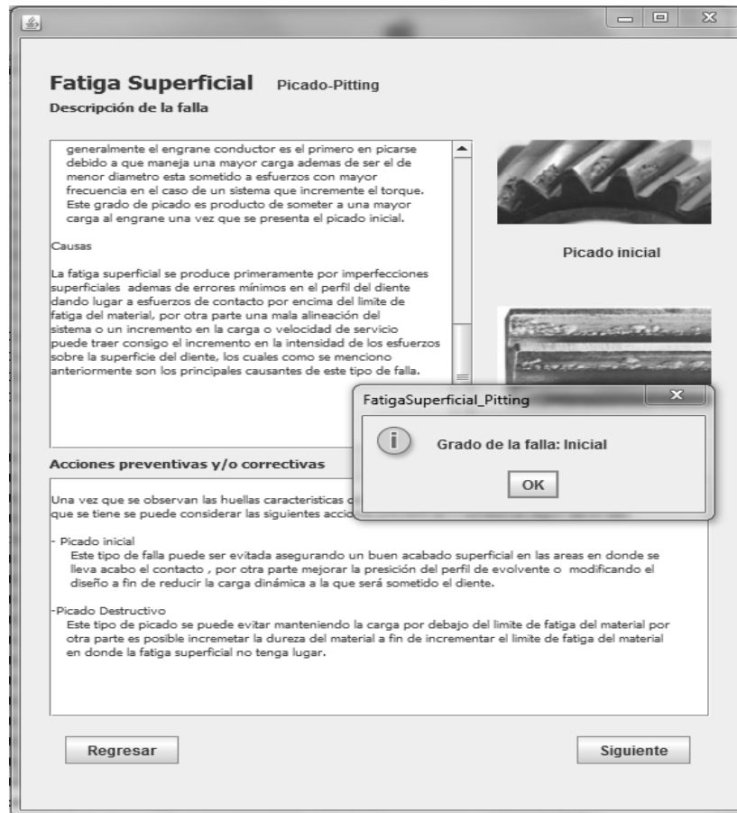
Figura 5.7. Descripción de la falla
