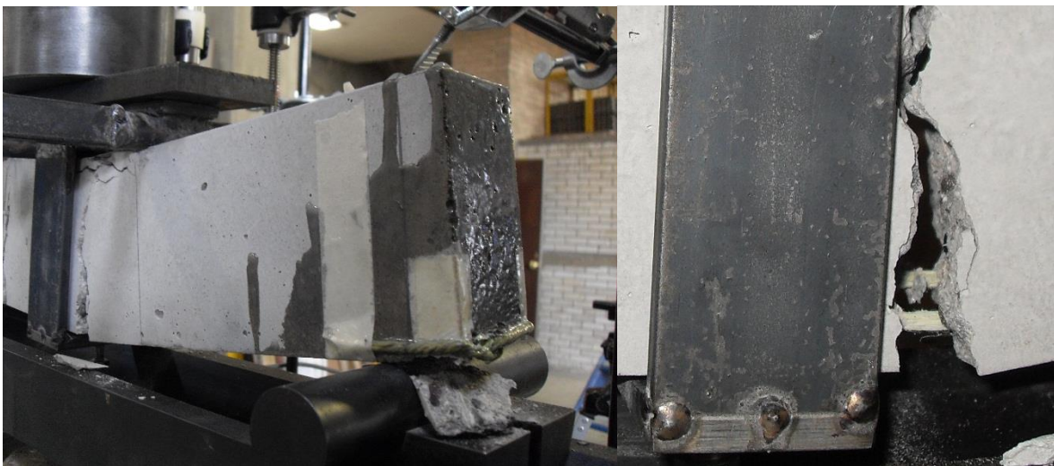
Figura 6.5.4.3b Falla del elemento después de la aplicación de la carga máxima de la viga VFK4
