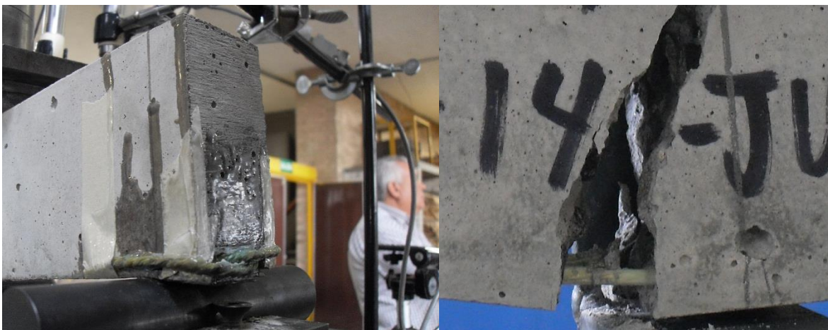
Figura 6.5.2.3b Falla del elemento después de la aplicación de la carga máxima de la viga VFK2
