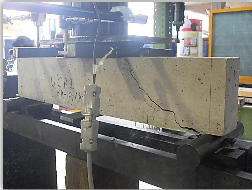
Figura 6.4.1.3a Falla del elemento después de la aplicación de la carga máxima de la viga VCA1
