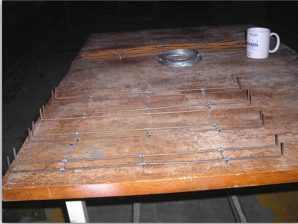
Figura 5.6.1a Alambres corrugados cortados de la malla electrosoldada
