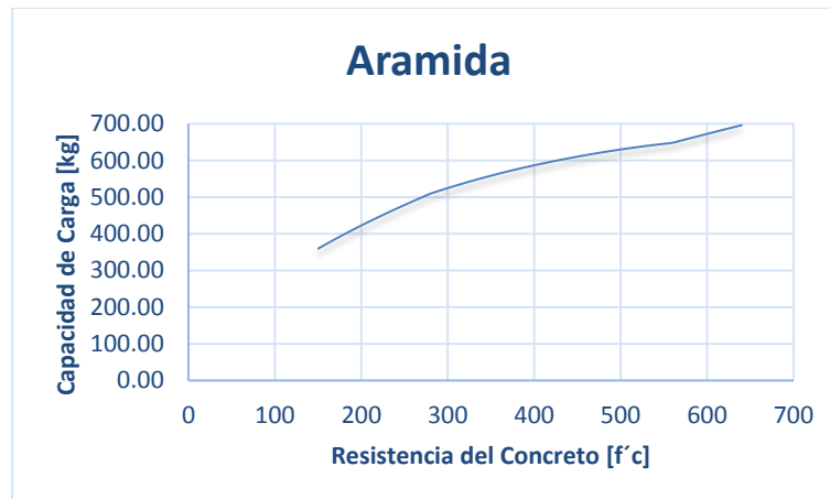
Figura 6.6c Sensibilidad de f'c en la capacidad de carga por flexión de las vigas planteadas reforzadas con Aramida
