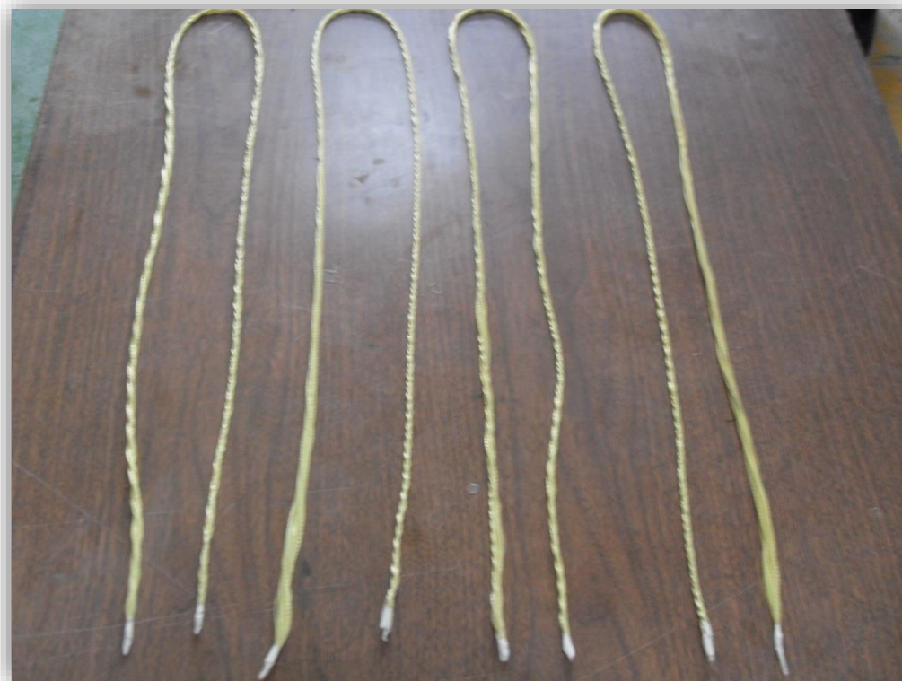
Figura 5.7.1c Hilos de Aramida compuestos por 8 hilos simples entrelazados, listos para ser colocados como refuerzo longitudinal
