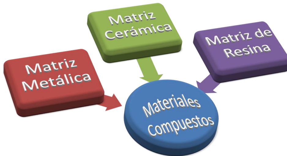
Figura 2.3d Clasificación de los materiales compuestos atendiendo a su matriz o fase continua
