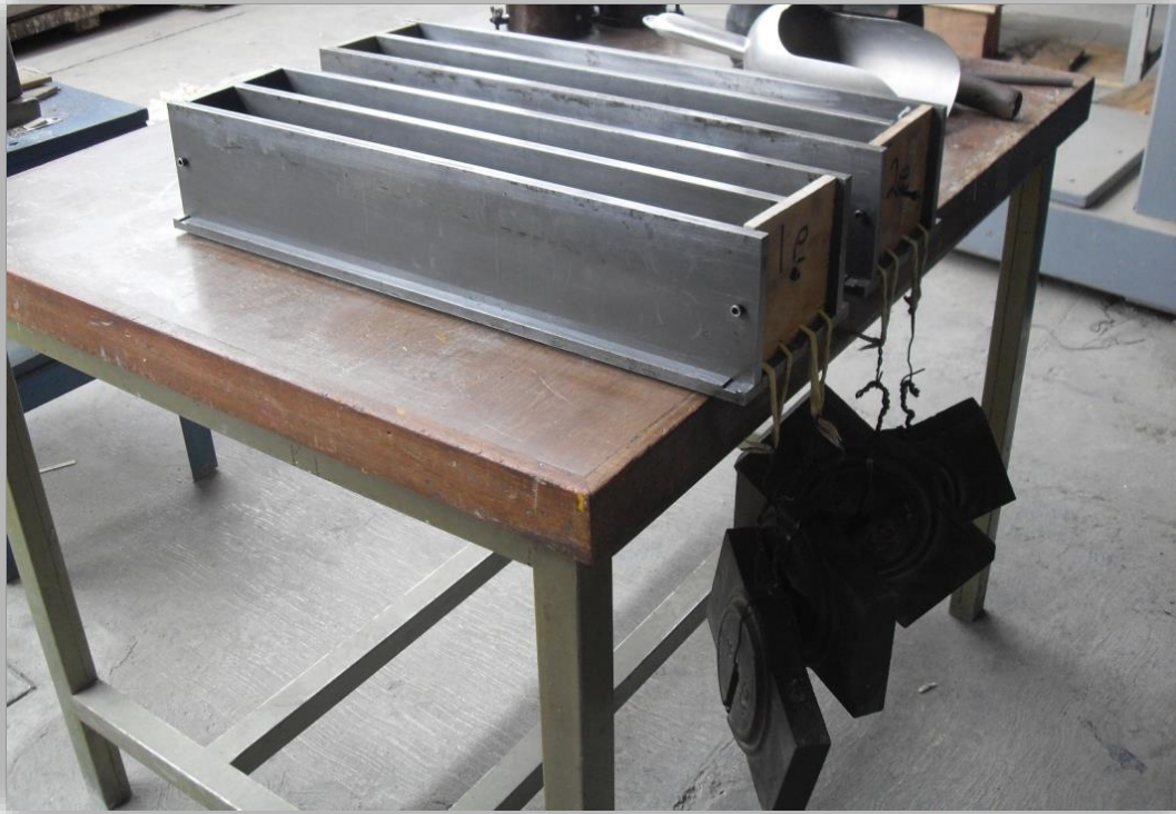
Figura 5.7.2b Pretensado de los refuerzos de fibras de Aramida para las vigas ensayadas
