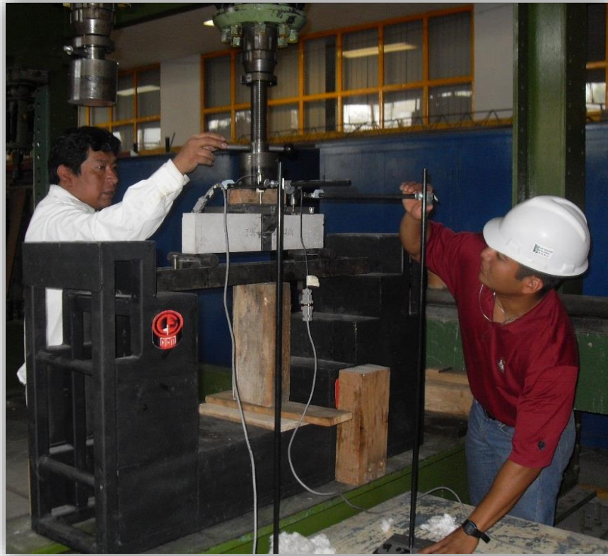
Figura 5.3h Transformadores diferenciales usados para registrar las deflexiones de las vigas.
