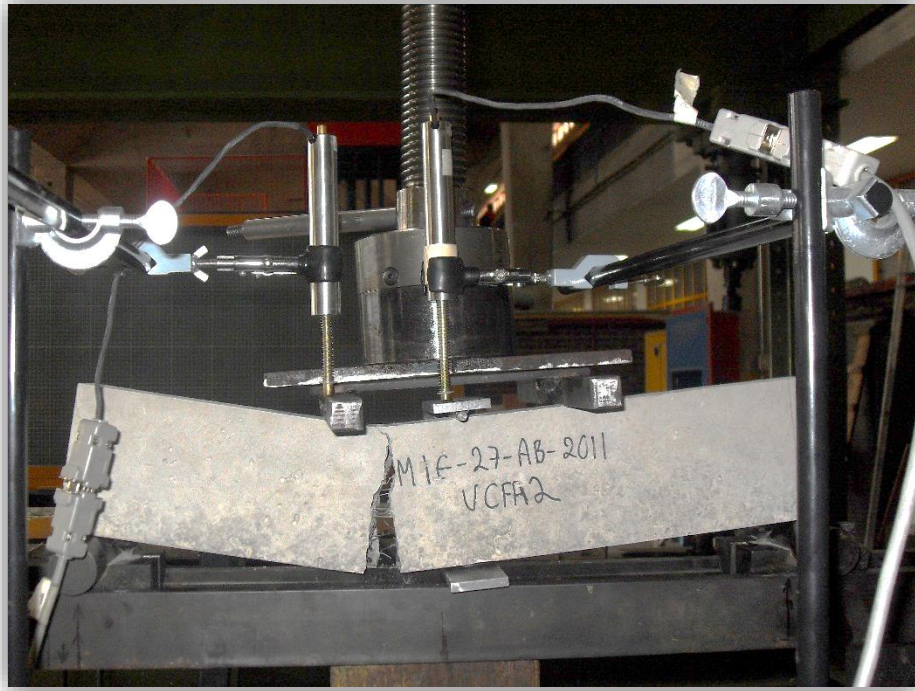
Figura 6.3.2.3a Falla del elemento después de la aplicación de la carga máxima de la viga VFA2
