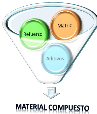
Figura 2.3b Componentes en el diseño de un material compuesto avanzado
