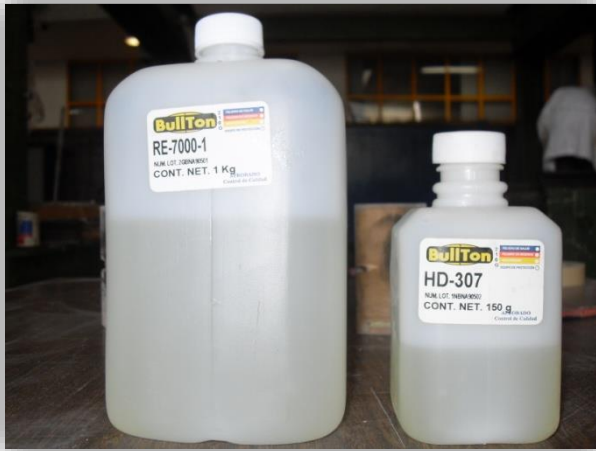
Figura 5.7.2d Resina epóxica utilizada para fijar los tramos sobrantes de los refuerzos a la superficie de concreto de la viga
