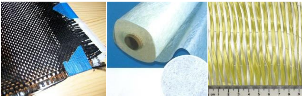
Figura 2.3c Fibras de carbono, vidrio y Aramida respectivamente
