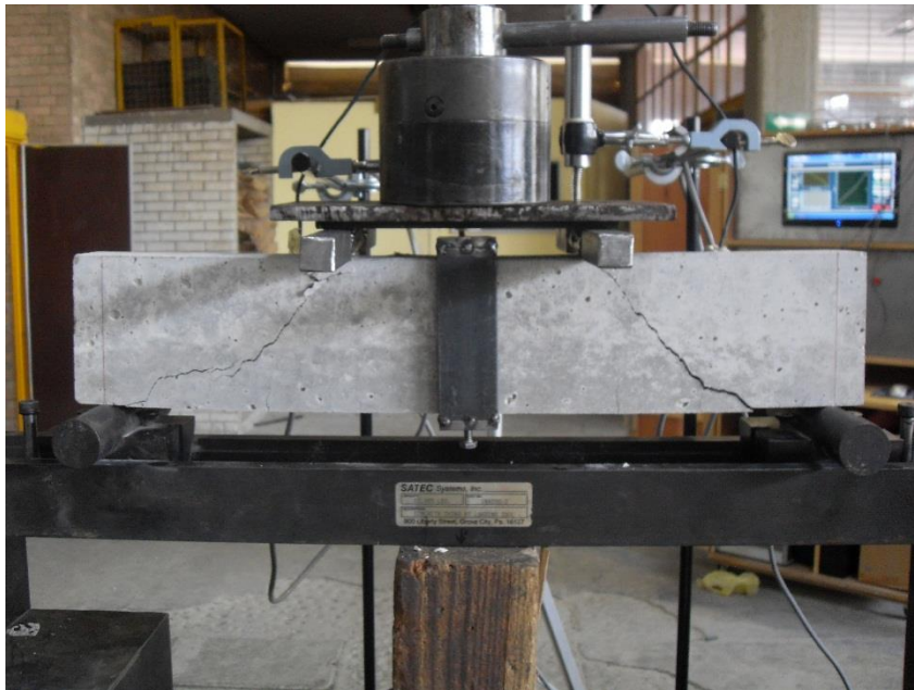
Figura 6.4.3.3b Falla del elemento después de la aplicación de la carga máxima de la viga VCA3
