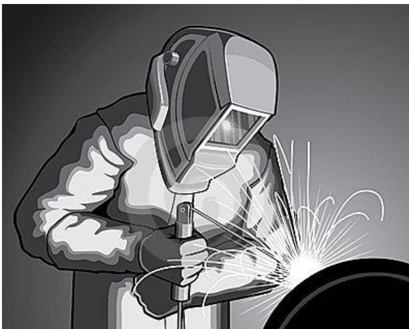
Figura 3.5.1 Aplicación de soldadura eléctrica
