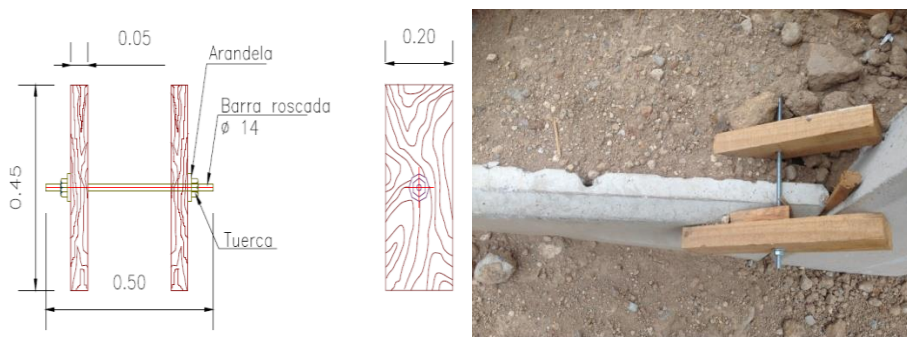
Fig. 5. 22 Pernos de Rigidización de Paneles de Concreto o Sargentos
