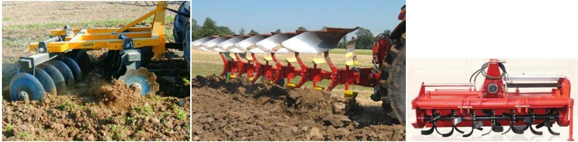
Ilustración 4.2 Grada de disco, arados de rejas y rotavator.
