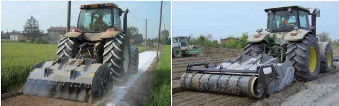
Ilustración 4.3 Estabilizador de suelo
