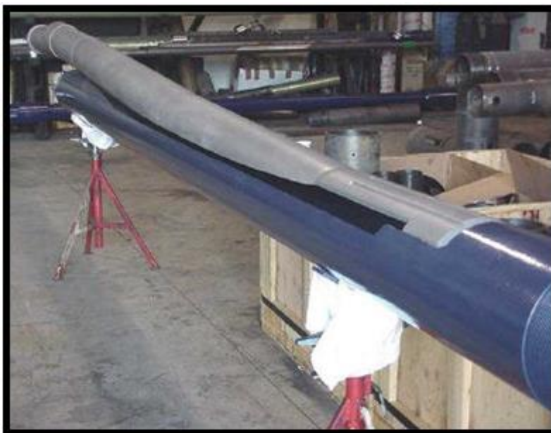
Fig. 4.1 Ventana de articulación pre-perforada del sistema SLB RapidTieback™
