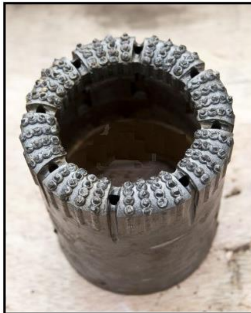
Fig. 2.6 Barrena de diamante.
