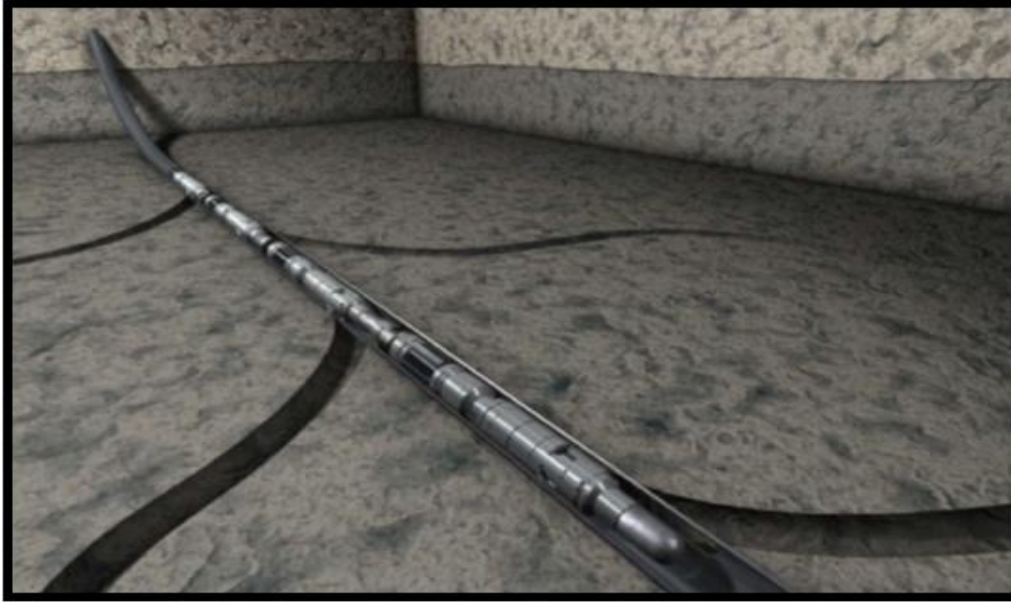
Fig. 5.3 Terminación inteligente en el pozo principal de un multilateral para aislar y controlar la afluencia de cada lateral.
