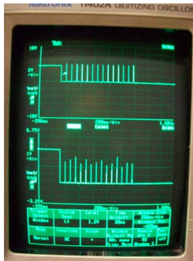
Figura 5.5: Señal de error y voltaje de salida de CI BQ24314
