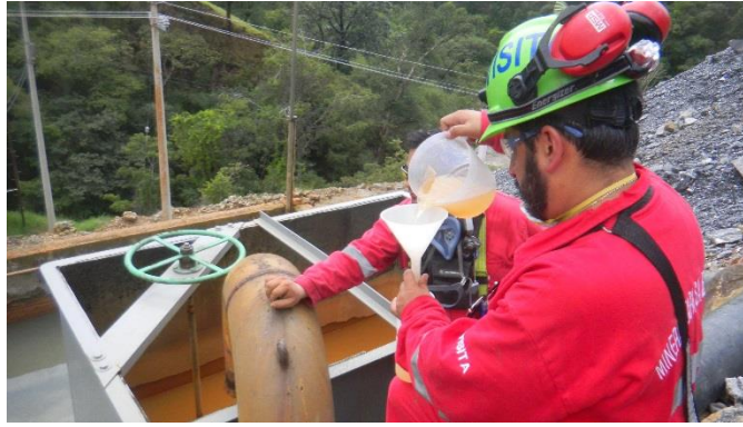
Figura 20. Toma de muestra del agua bombeada de la mina
