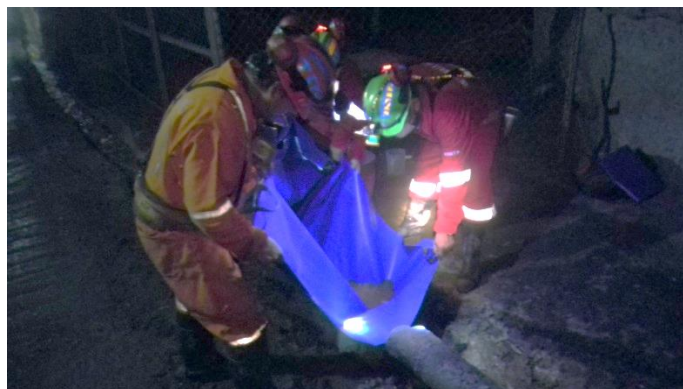
Figura 57. Medición del volumen de agua de tuberías
