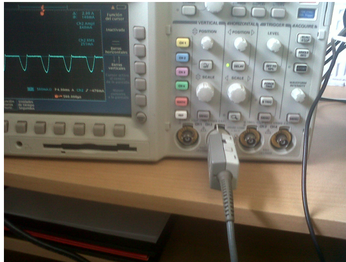
Figura 2.11: Montaje para la medición de corriente
