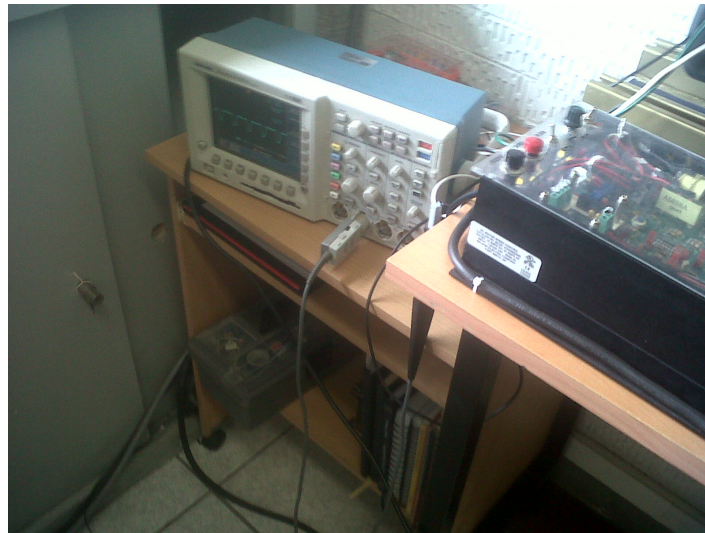
Figura 2.12: Pinza de corriente en la armadura del motor
