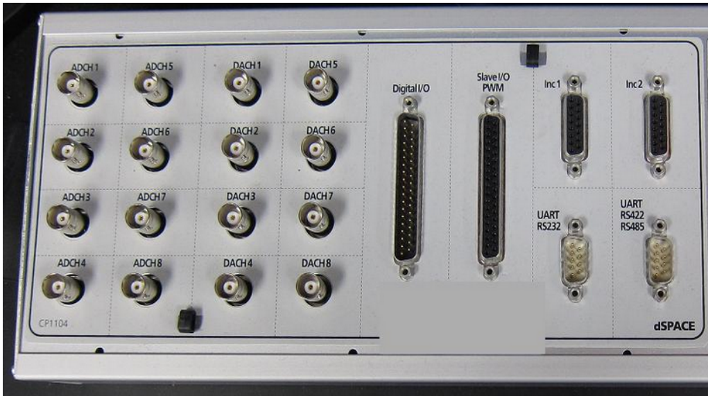
Figura 3.28: Vista superior de la tarjeta dSPACE
