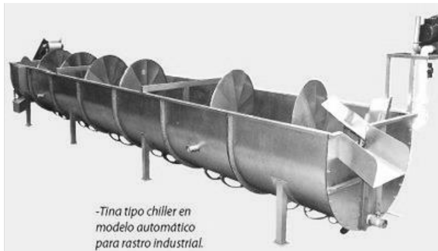
Figura 3.4. Tina tipo chiller, con agua a temperatura de 0 a 4 °C Fuente: http://www.engormix.com/MA-avicultura
