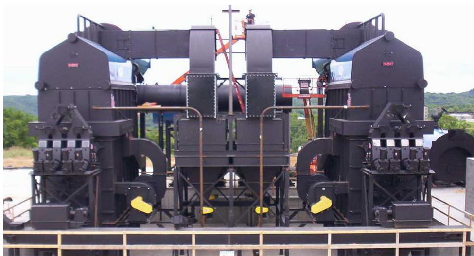
Figura 3.7. Caldera para biomasa
