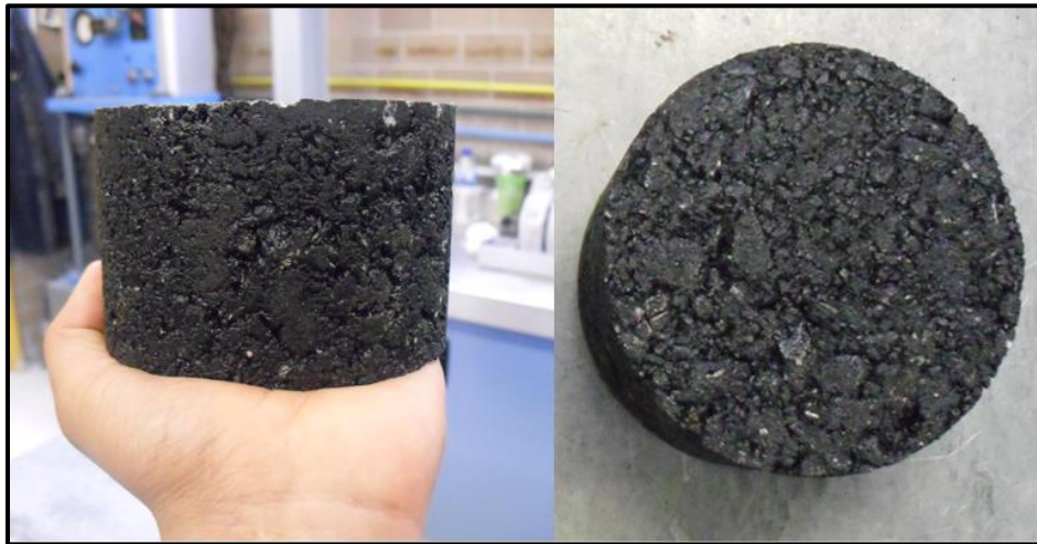
Figura 2-3 Mezcla asfáltica densa, compactada con el martillo Marshall
