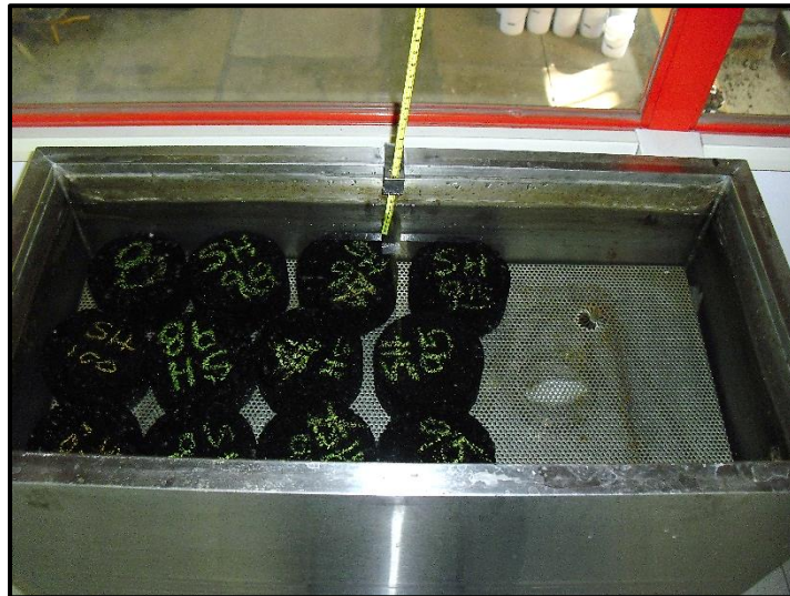
Figura 5-39 Especímenes Marshall durante el ciclo de descongelamiento
