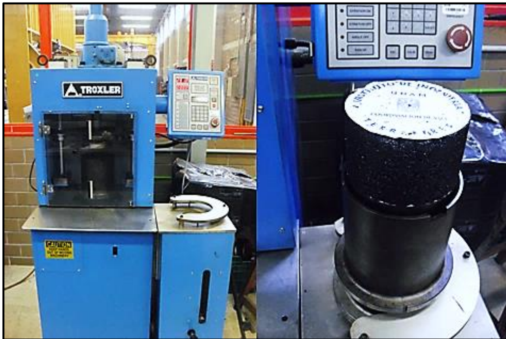
Figura 4-29 Compactación de probetas en el Compactador Giratorio Superpave
