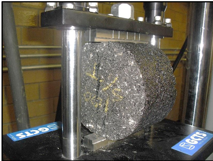
Figura 5-25 Ruptura de probeta Superpave, probada a Tensión indirecta
