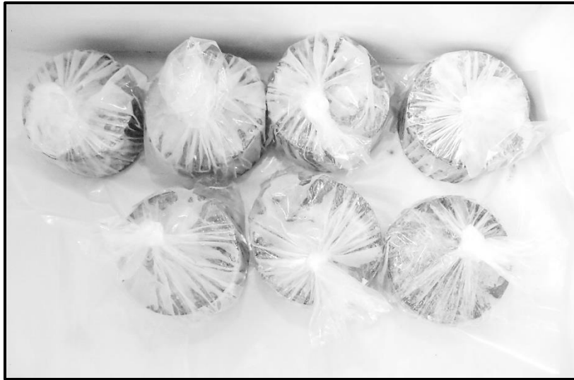
Figura 5-33 Especímenes Superpave durante el ciclo de congelamiento a -18^{\circ}\text{C}
