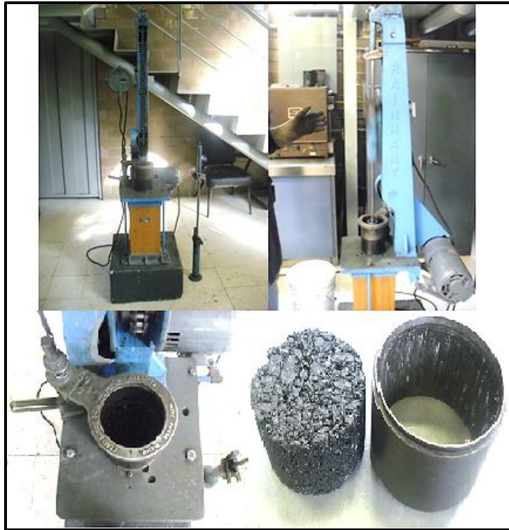
Figura 4-30 Procedimiento de compactación Marshall
