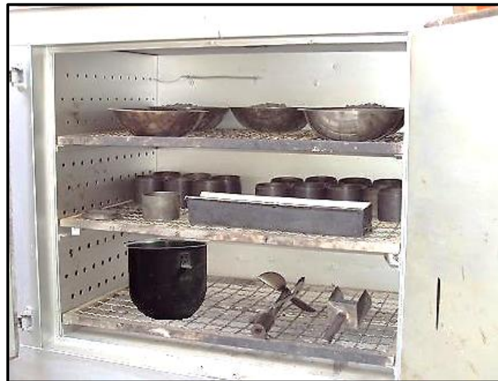
Figura 4-26 Agregado pétreo, moldes y utensilios en horno
