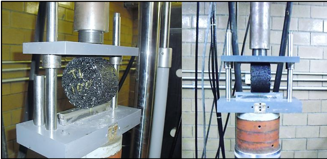
Figura 5-21 Configuración de la prueba de Tensión Indirecta en especímenes Marshall
