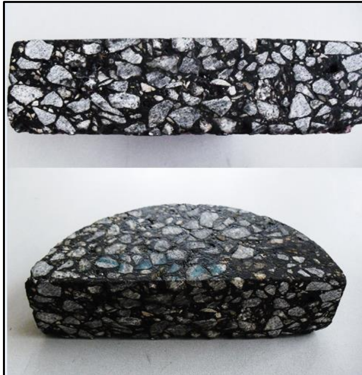
Figura 2-5 Mezcla asfáltica de granulometría discontinua SMA
