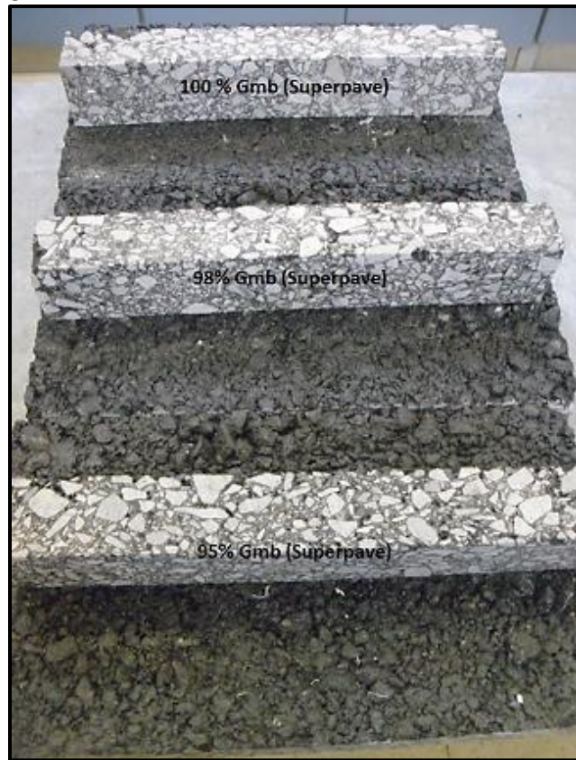
Figura 5-12 Vigas cortadas para ensayo de fatiga
