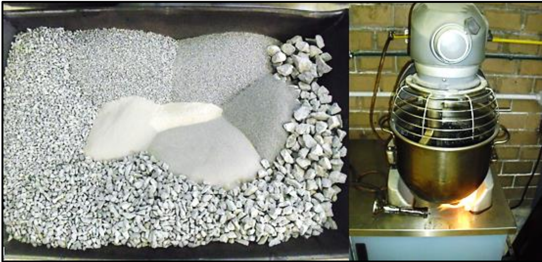
Figura 4-44 Dosificación y mezclado de placas para deformación plástica
