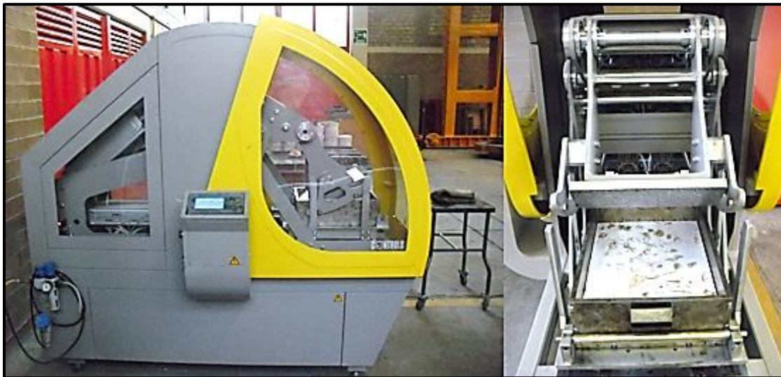
Figura 4-45 Compactador de rodillo
