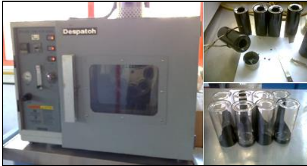
Figura 4-13 Horno rotatorio de película delgada
