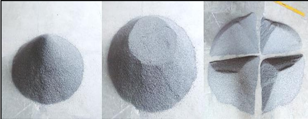
Figura 4-18 Homogenización y cuarteo del material pétreo
