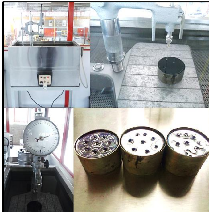
Figura 4-10 Ensayo de penetración en el asfalto
