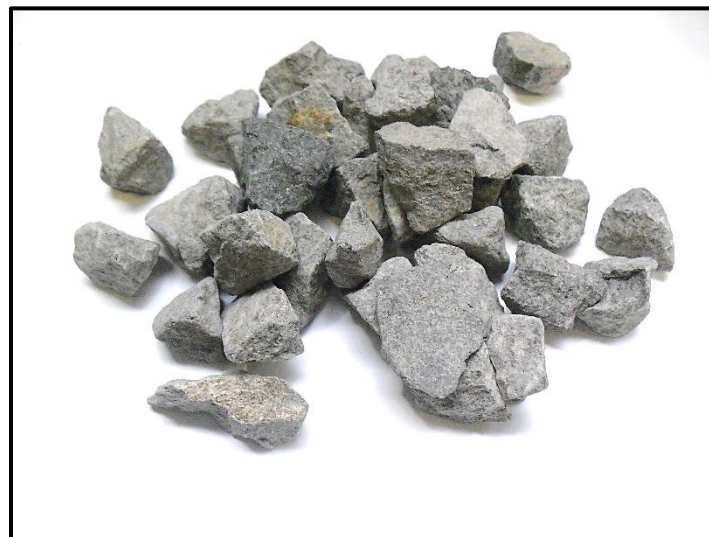
Figura 4-8 Caras fracturadas en el agregado grueso
