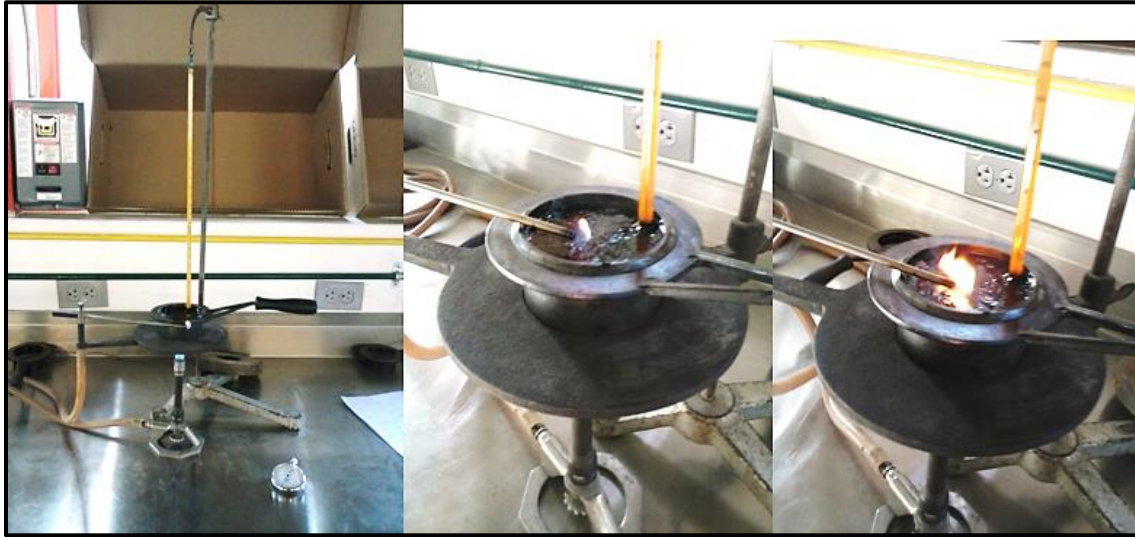
Figura 4-11 Ensayo de punto de inflamación
