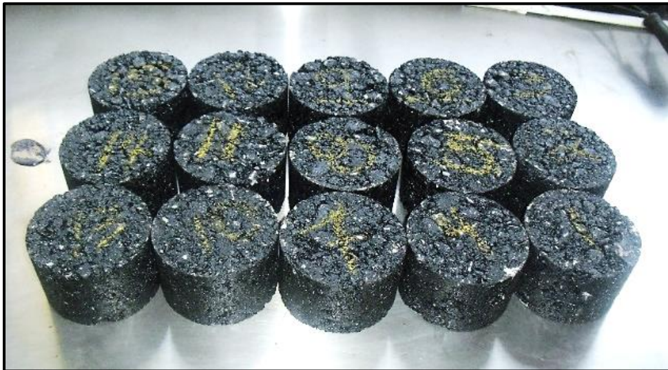
Figura 4-34 Probetas del diseño Marshall
