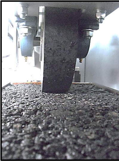
Figura 5-5 Rueda apoyada en el espécimen
