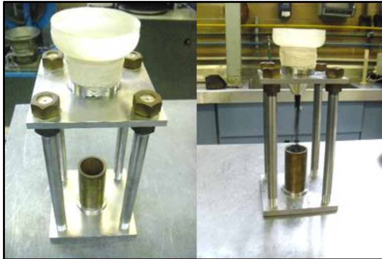
Figura 4-7 Dispositivo para medir la angularidad del agregado fino
