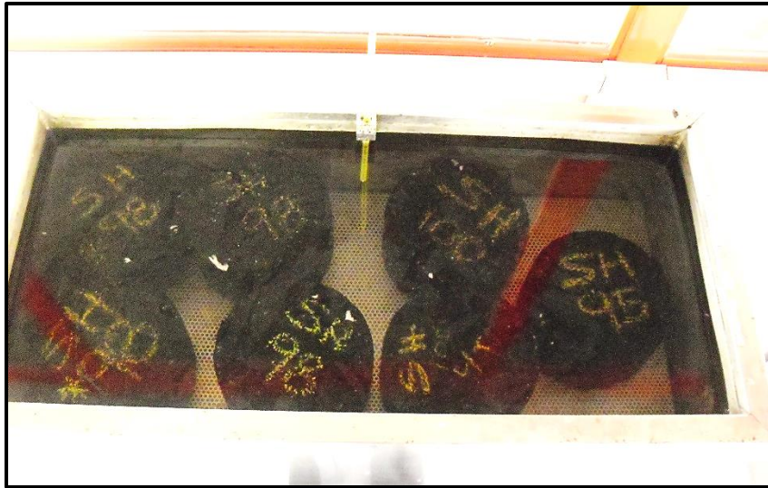
Figura 5-35 Especímenes Superpave durante el ciclo de descongelamiento a 60°C
