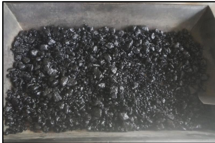
Figura 2-1 Mezcla asfáltica densa elaborada en laboratorio
