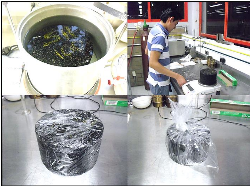
Figura 5-32 Saturación de las probetas, como parte del acondicionamiento para el ensayo de Susceptibilidad a la humedad
