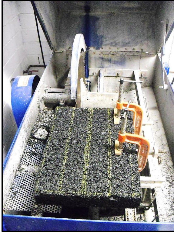
Figura 4-46 Corte de placas para obtener vigas
