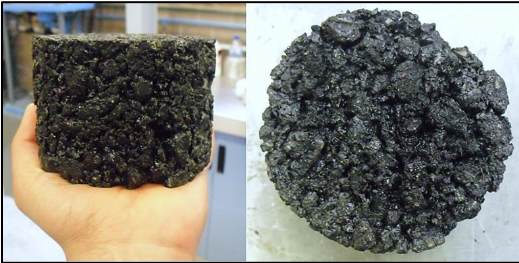
Figura 2-4 Mezcla asfáltica en caliente con granulometría abierta
