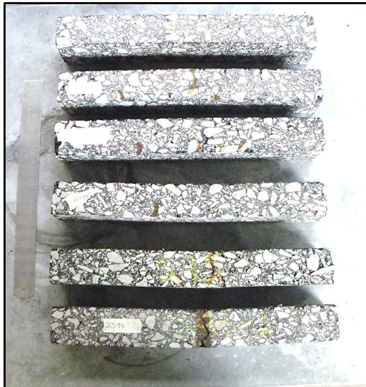
Figura 5-15 Vigas después del ensayo
