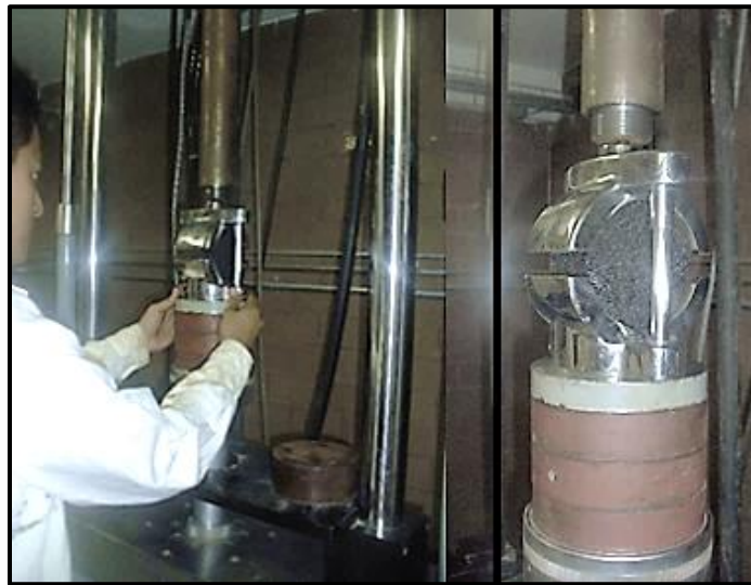
Figura 4-36 Configuración de prueba de estabilidad y flujo Marshall
