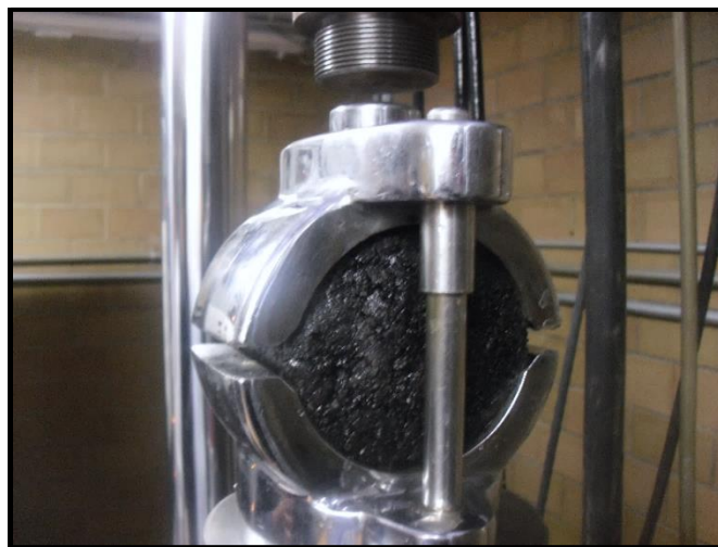
Figura 4-37 Fin de la prueba de estabilidad y flujo Marshall
