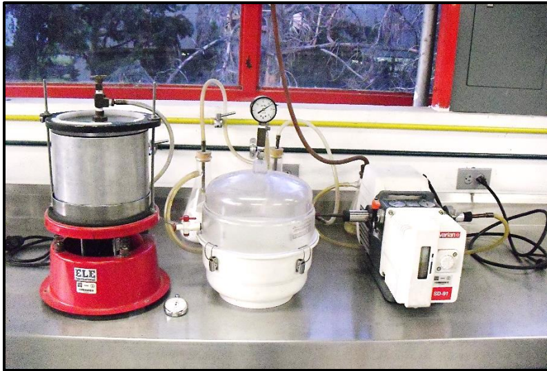
Figura 4-32 Bomba y Picnómetro para determinar la gravedad específica máxima teórica
