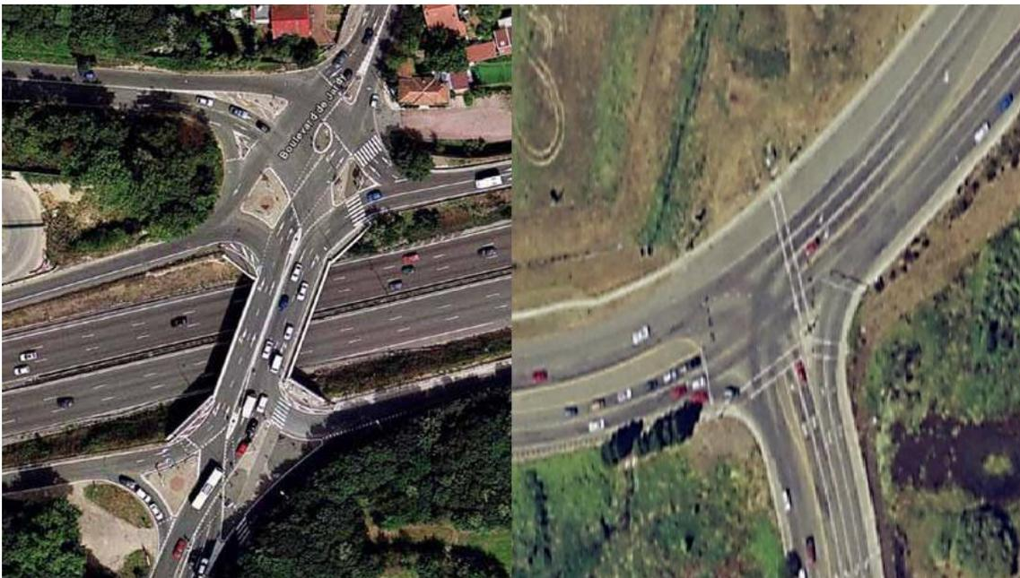
**Figura 2-1 Paso a desnivel (derecha) y entronque (izquierda)**
