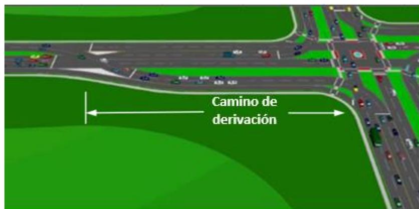
**Figura 2-7** Detalle de una intersección de flujo paralelo
