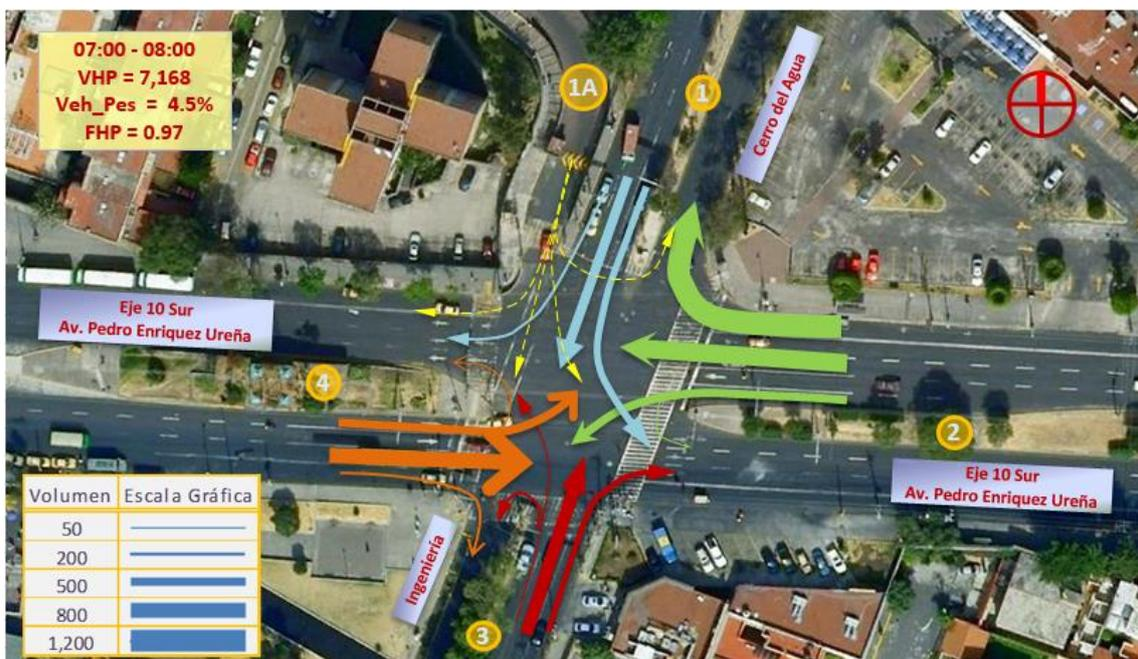
**Figura 5-2 Diagrama representativo de los movimientos en la intersección**
