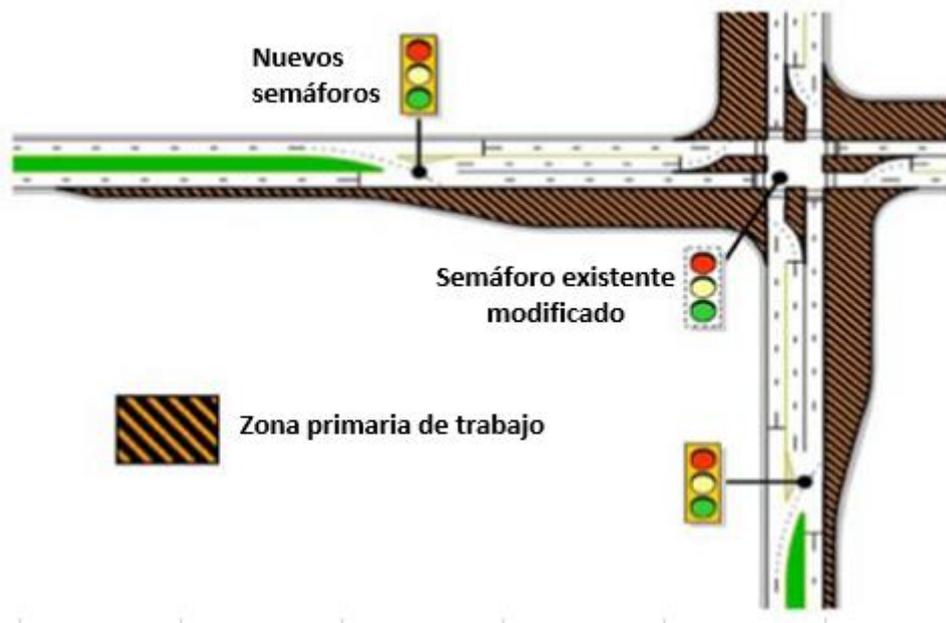
**Figura 2-11 Zonas de trabajo principales en la construcción de una PFI**
