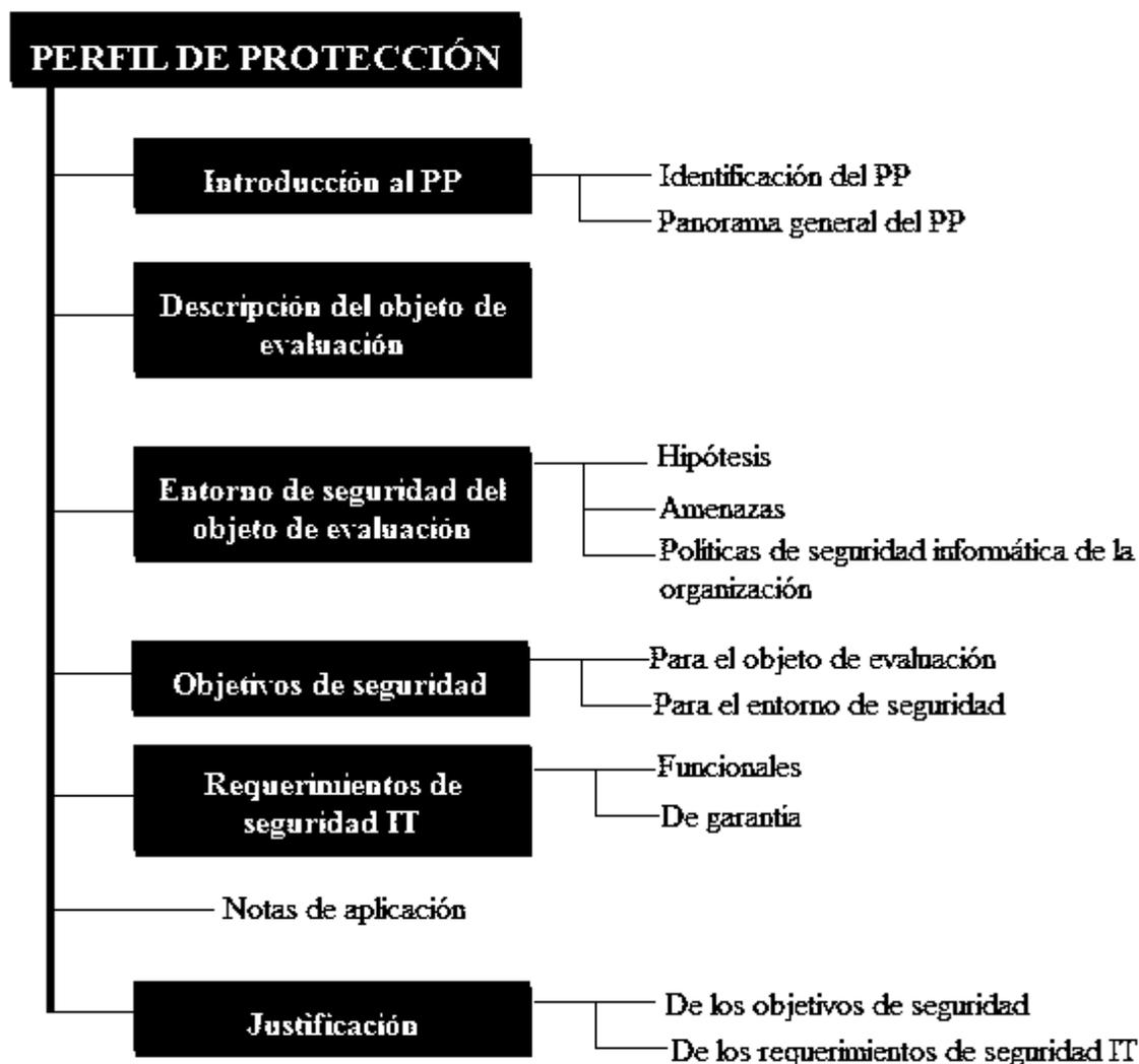
Figura 4.6 Contenido del perfil de protección
