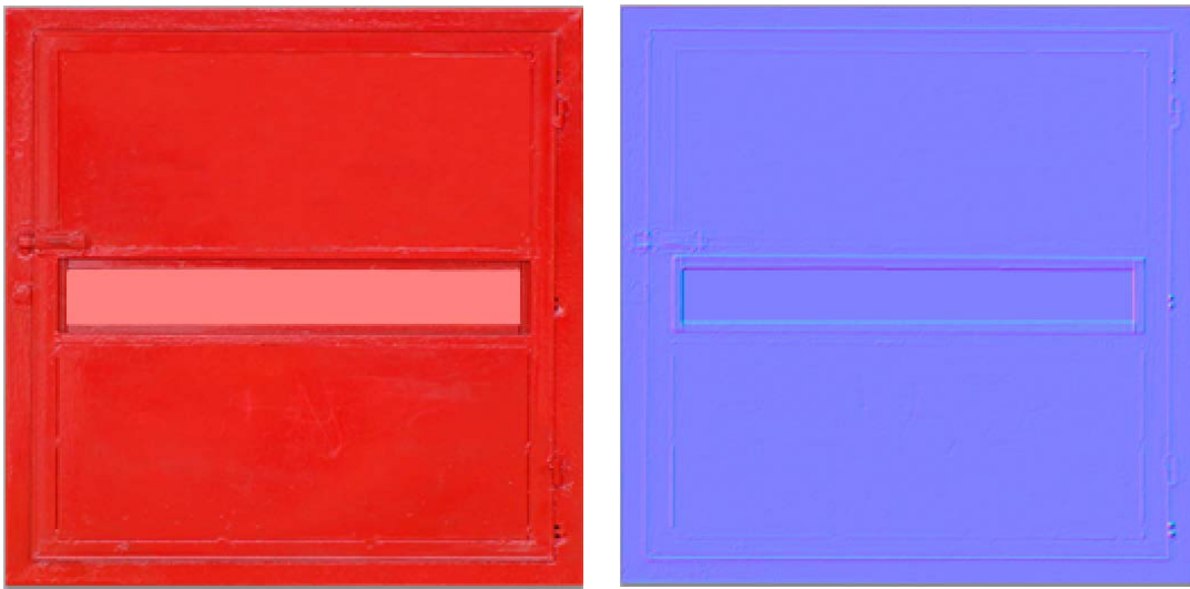
Fig. 23.4. Del lado izquierdo tenemos la textura difusa del hidrante, la parte rosa es un canal alfa. Del lado derecho tenemos su mapa de normales.
