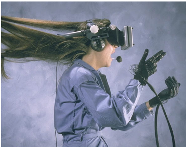
Fig. 1.7.2. DataGlove siendo usado en conjunto con un HMD, permitiendo una inmersión mayor en los ambientes virtuales.
