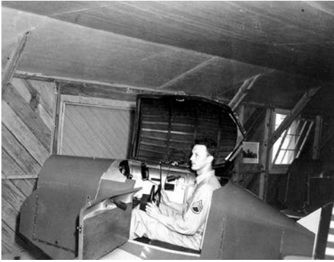
Fig. 1.1. Piloto a bordo de un Link Trainer. Con este simulador de vuelo. Se entrenó a cientos de pilotos durante la guerra.
