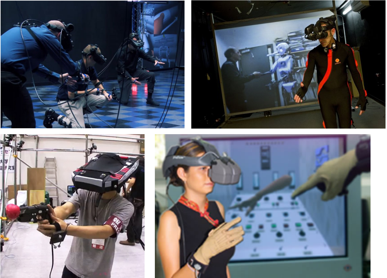
Fig. 4. Podemos observar los diferentes accesorios usados para la realidad virtual inmersiva, desde cascos o visores, hasta guantes y otras herramientas usadas para interactuar en el ambiente virtual.
