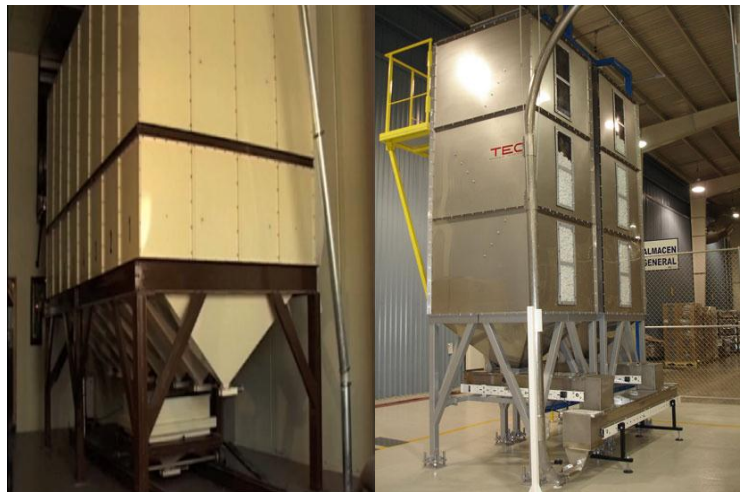
Fig. 2.9 Silos metálicos de sección cuadrada
