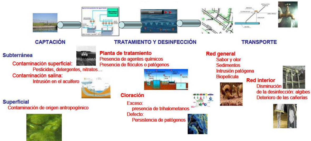
Figura 4.1 Problemas relacionados con la calidad que aparecen en las redes de distribución de agua (López Jiménez, Mora Rodríguez, Salas Lechuga, & Martínez Solano, 2007)
