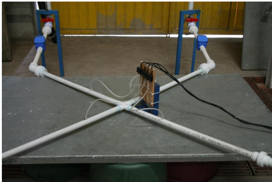
Figura 5.8 Sensores de presión conectados a la tubería
