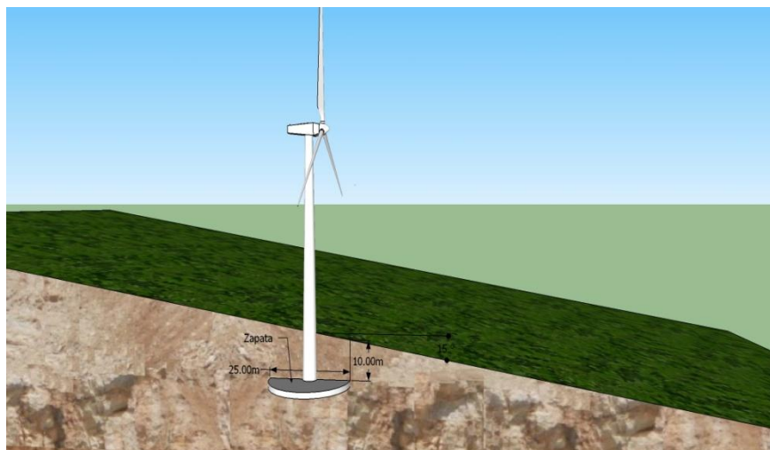
Figura 5.10 Representación idealizada de cimentación
