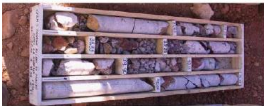
Figura 2.7 Muestreo en rocas, colocación en cajas
