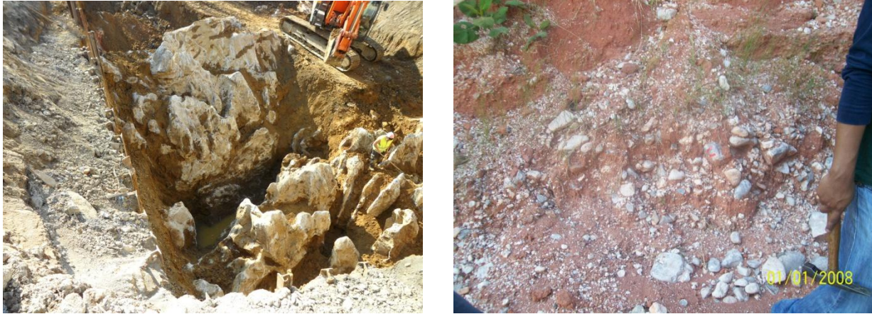
Figura 4.3 Roca muy alterada, predominan rellenos
