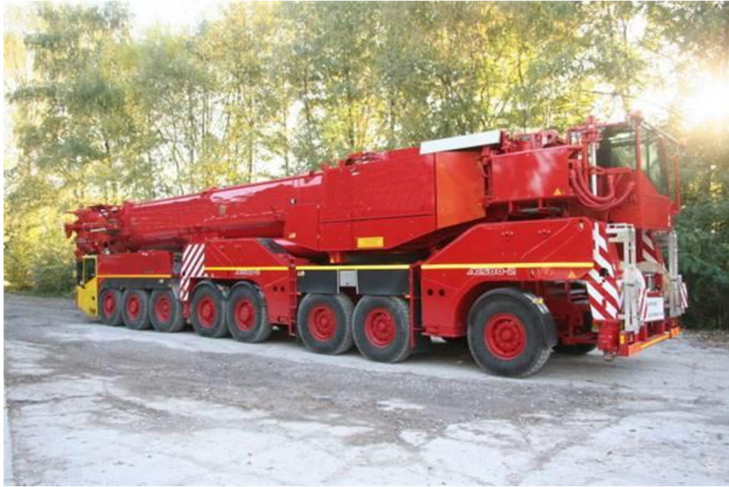
Ilustración 80. “Grúa Terex de 500 toneladas”
