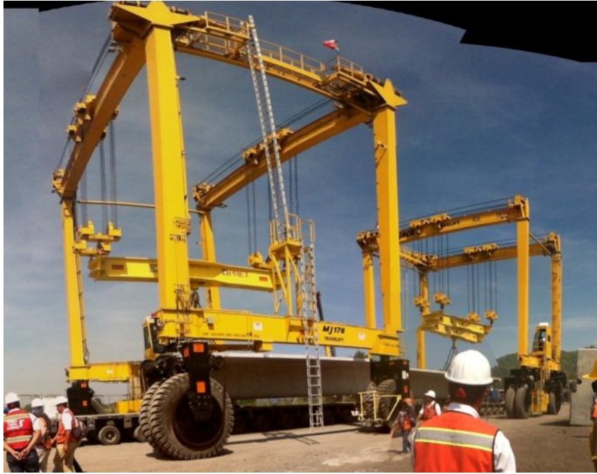
Ilustración 72. “Grua de portico cargando modular”
