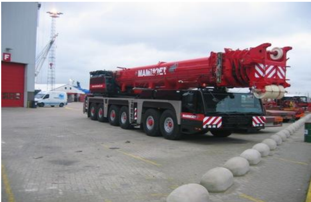
Ilustración 81. “Grúa Terex de 350 toneladas”
