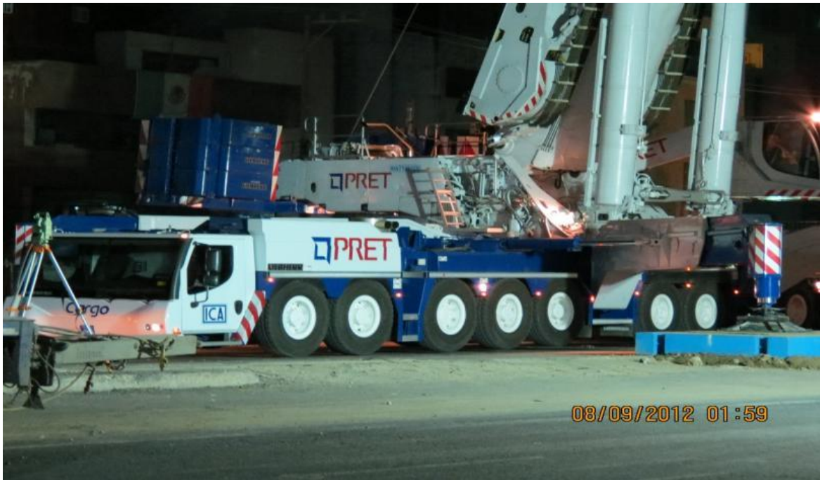
Ilustración 73. “Grúa de 1200 tons en acción”
