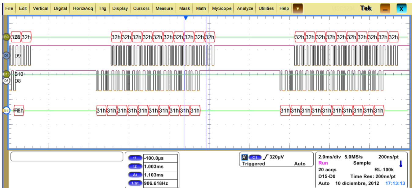
Figura 3.30. Prueba de comunicación full-duplex .
