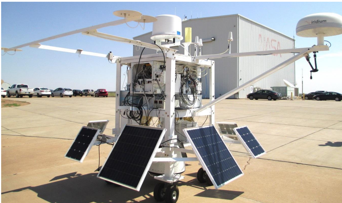
Figura 5.16. Góndola donde fue montado Pixqui.
