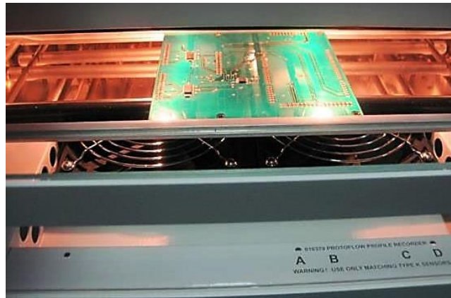
Figura 3.77. Tarjeta en el horno de reflujo.
