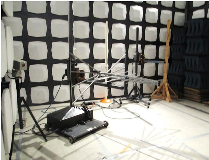
Figura 5.13. Antenas de la cámara semi-anechoica.
