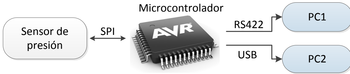
Figura 3.36. Esquema de comunicación SPI y RS-422.
