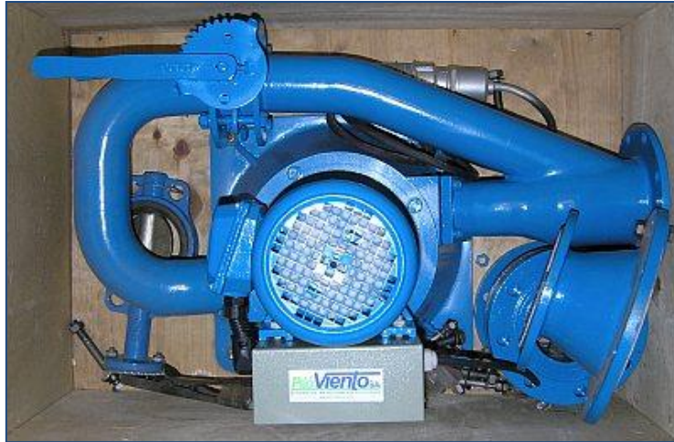
Figura IV-6.-Turbina Turgo de 110 KW. Fuente: Pro Viento.ec
