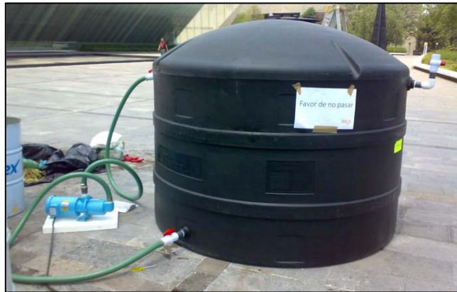
Figura 4.10 Sistema de alimentación y recirculación
