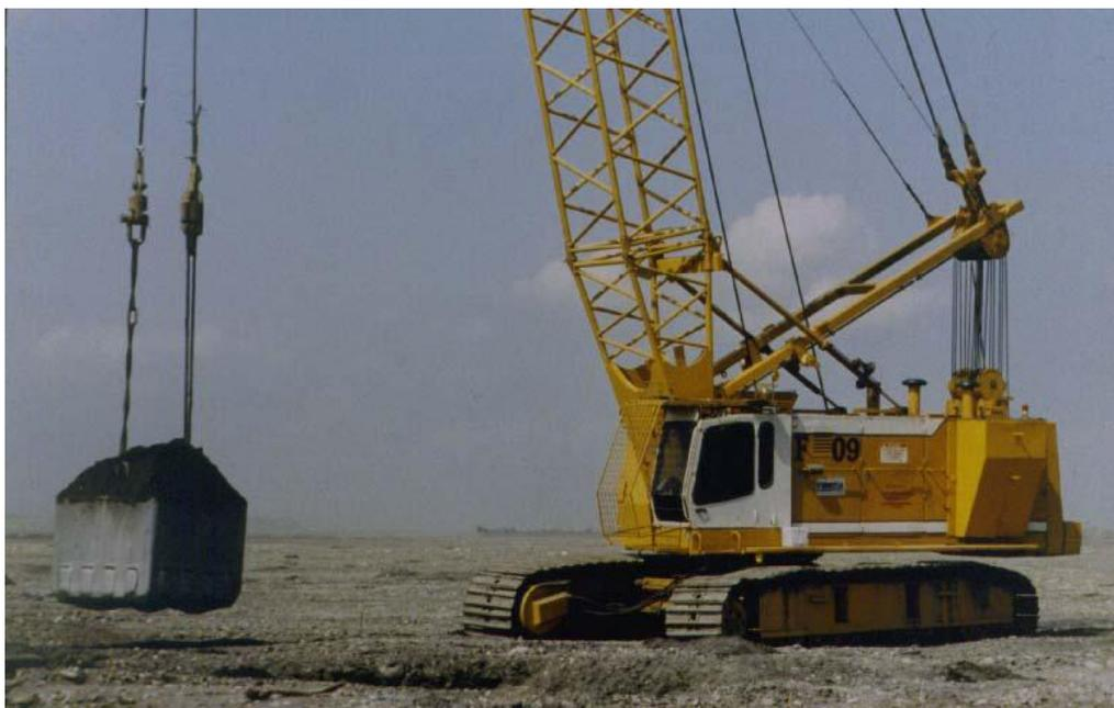
*Figura 4.2 Masa de acero suspendida para compactación dinámica (Hayward Baker Inc.).*
