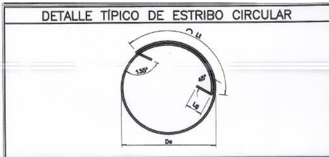
Fig.17 – Detalle típico de estribo circular.
