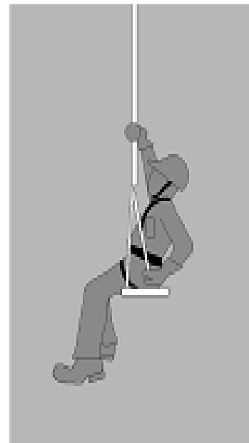
Sistema de ascenso/descenso controlado
