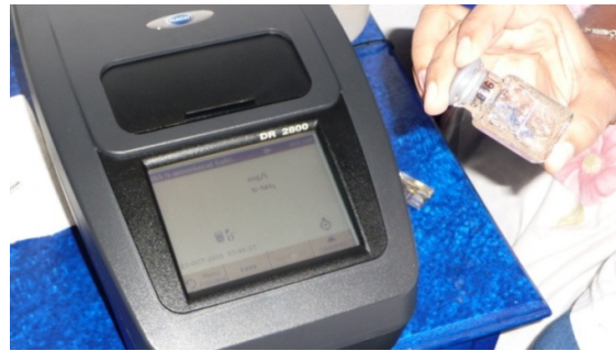
Figura 4.10. Manejo y operación de espectrofotómetro HACH DR 2800
