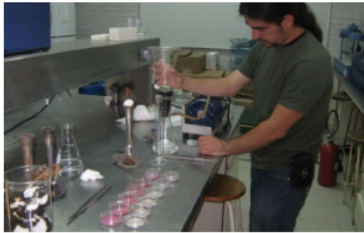
Figura 4.11. Método de filtración con membrana
