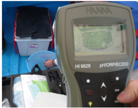
Figura 4.5 Medidor multiparamétrico con GPS HI 9828
