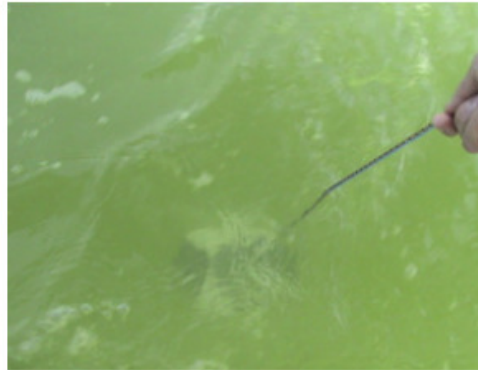
FIG. 4.9. Determinación de la turbiedad mediante el disco de Secchi
