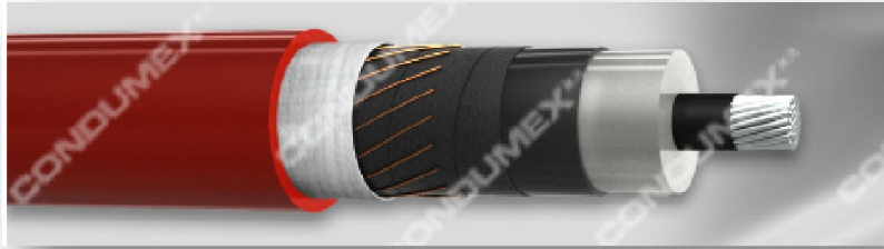
Figura 3.10 Cable vulcanel monoconductor con aislamiento XLP 133% nivel de aislamiento de 25 kV, Sellado cableado clase B, y cubierta de PCV.
