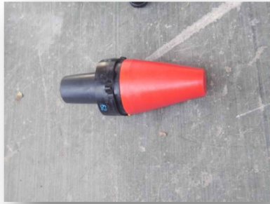
Figura 3.7 Conector tipo codo operación con carga de 23 kV, 200A.
