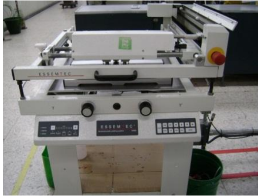
Fig. 26.- Impresora para aplicación de soldadura.
