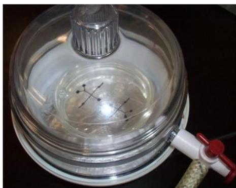
Figura 2.9 a) Desecador utilizado en el experimento.
