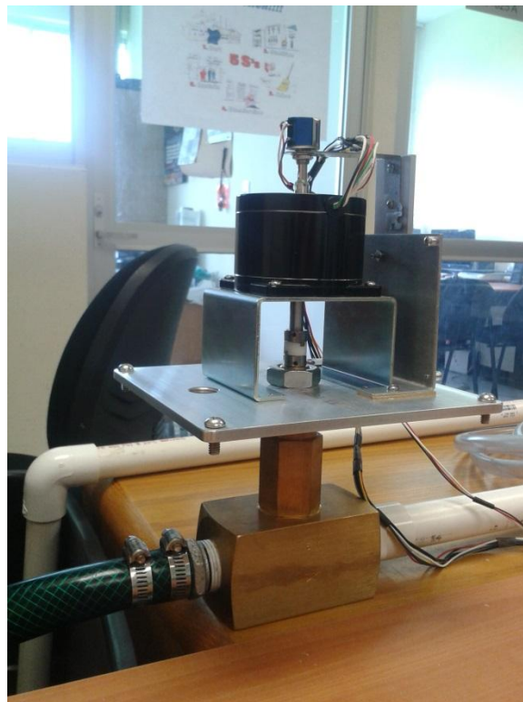
Figura 3.43: Electroválvula PV-34B con potenciómetro.
