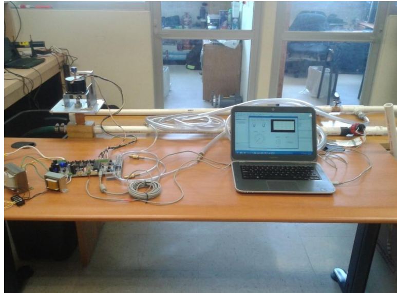
Figura 3.53: Circuito hidráulico de prueba.
