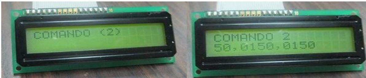
Figura 72: Respuesta al comando 2 enviado al medidor de vacío
