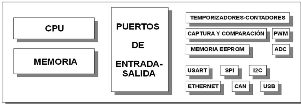
Figura 20: Microprocesador genérico
