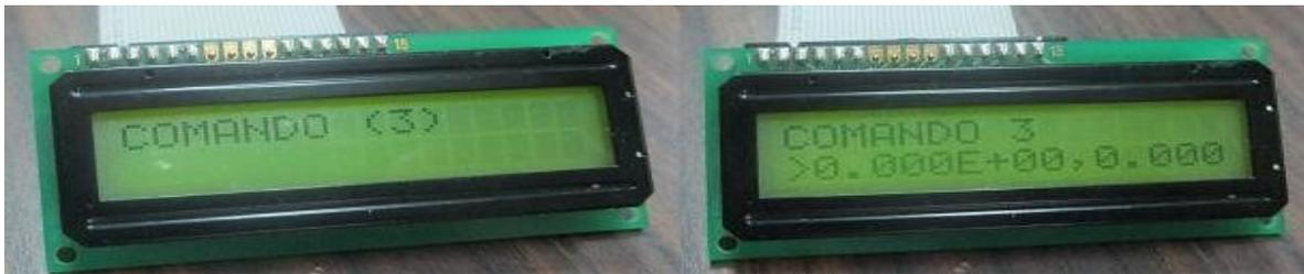
Figura 73: Respuesta al comando 3 enviado al medidor de vacío
