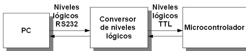
*Figura 13: Implementación de una comunicación RS-232*
