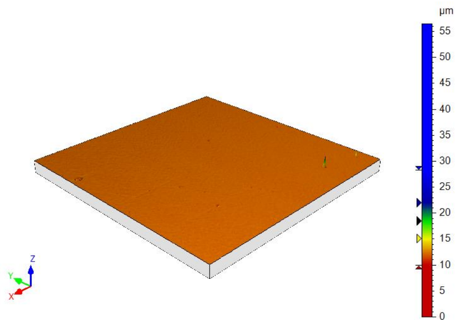
Figura 4.14 Perfil de rugosidad de una probeta Cu-5%Mg-1%Sn. Mechanical 3D®.
