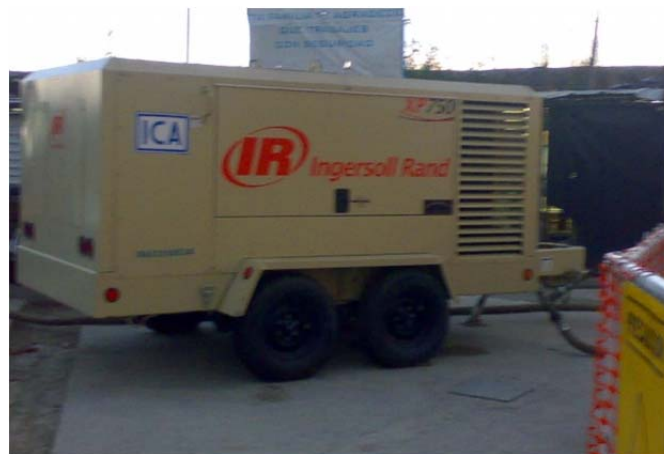
Fig. 2.5.9 Compresor para suministro de aire a presión
