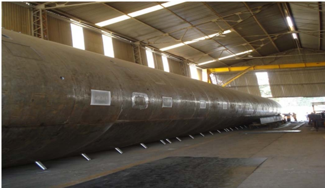
Fig. 2.5.3 Piernas de flotación de la cimbra.
