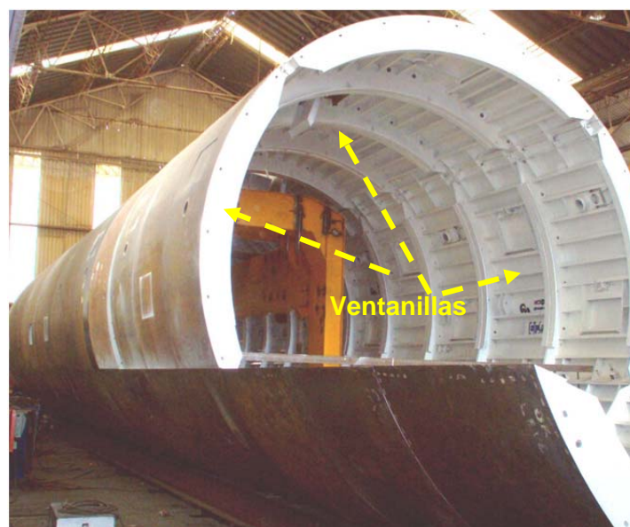
Fig. 2.5.2 Ventanillas de la Cimbra metálica telescópica.
