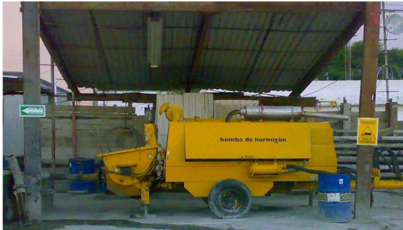
Fig. 2.5.10 Bomba para suministro de concreto
