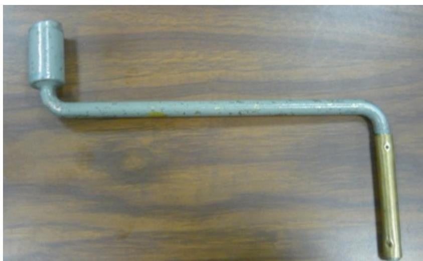
Fig. 3.12 Manivela para tensado del resorte para interruptor tipo Metal Clad
