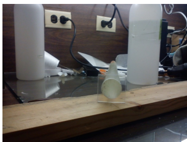
Figura 5.7: Corona para el arreglo 4 empotrada en la barra de Rexolite.
