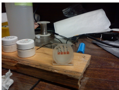
Figura 5.8: Fijado de la corona previo a colocación del PVDF.
