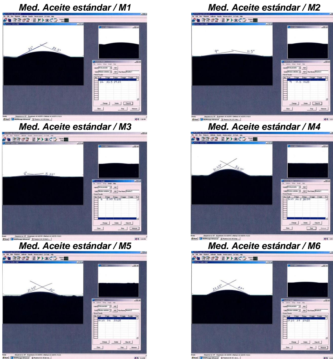
Figura 4.30 Evidencias de resultados con el método de gota sésil con aceite estándar como fase en estudio.
