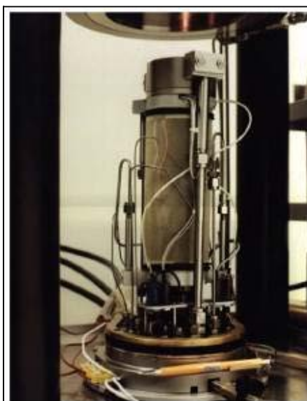
Figura 15. Equipo para medición de propiedades físicas de núcleos de sedimentos con hidratos (Winters et al, 2009).
