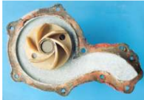
Figura 2.23 Bomba de Agua con Refrigerante Sin Aditivos
