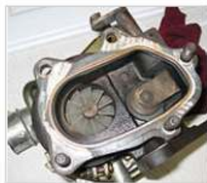
Salida del lado de baja presión de la turbina (izquierda) y válvula Waste-Gate en estado de reposo (cerrado)
