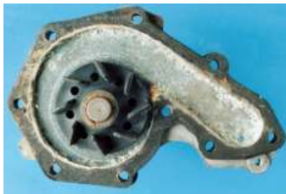
Figura 2.26 Bomba de Agua Sin Refrigerante
