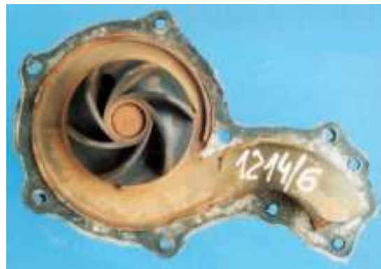
Figura 2.24 Bomba de Agua Sin Refrigerante
